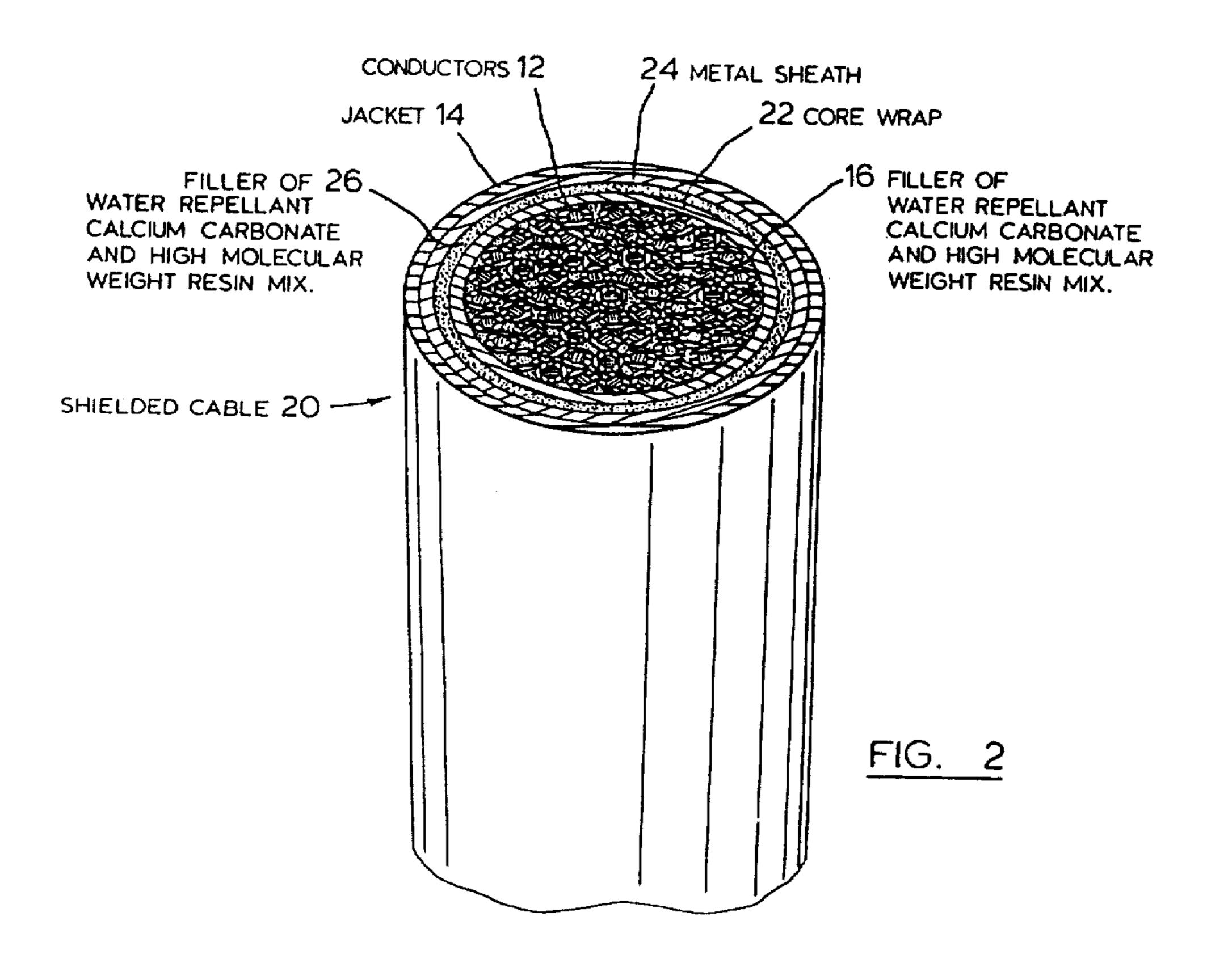
WATER BLOCKED ELECTRIC CABLES
