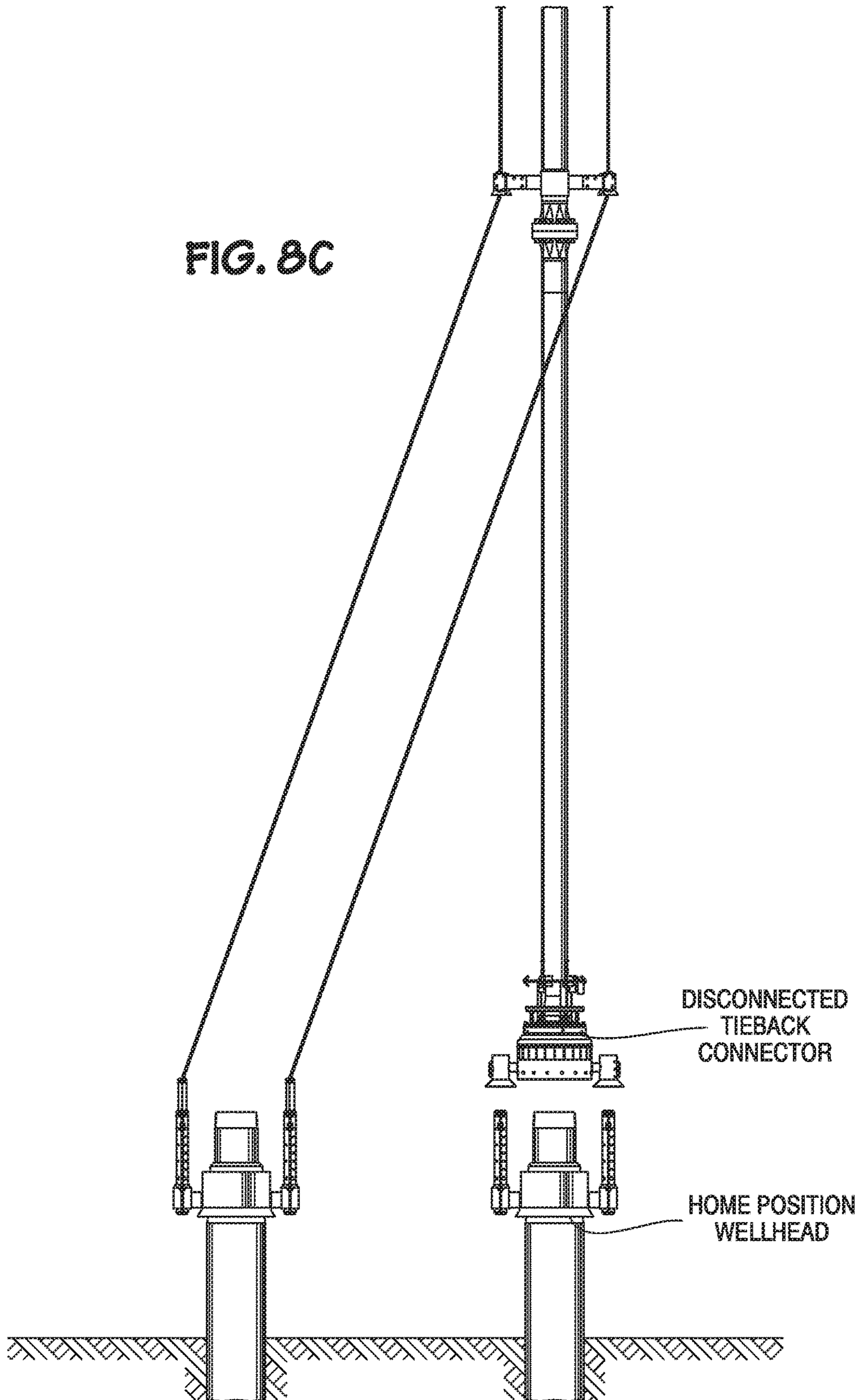
STEP 3: TIEBACK IS DISCONNECTED FROM HOME POSITION. VERTICAL
