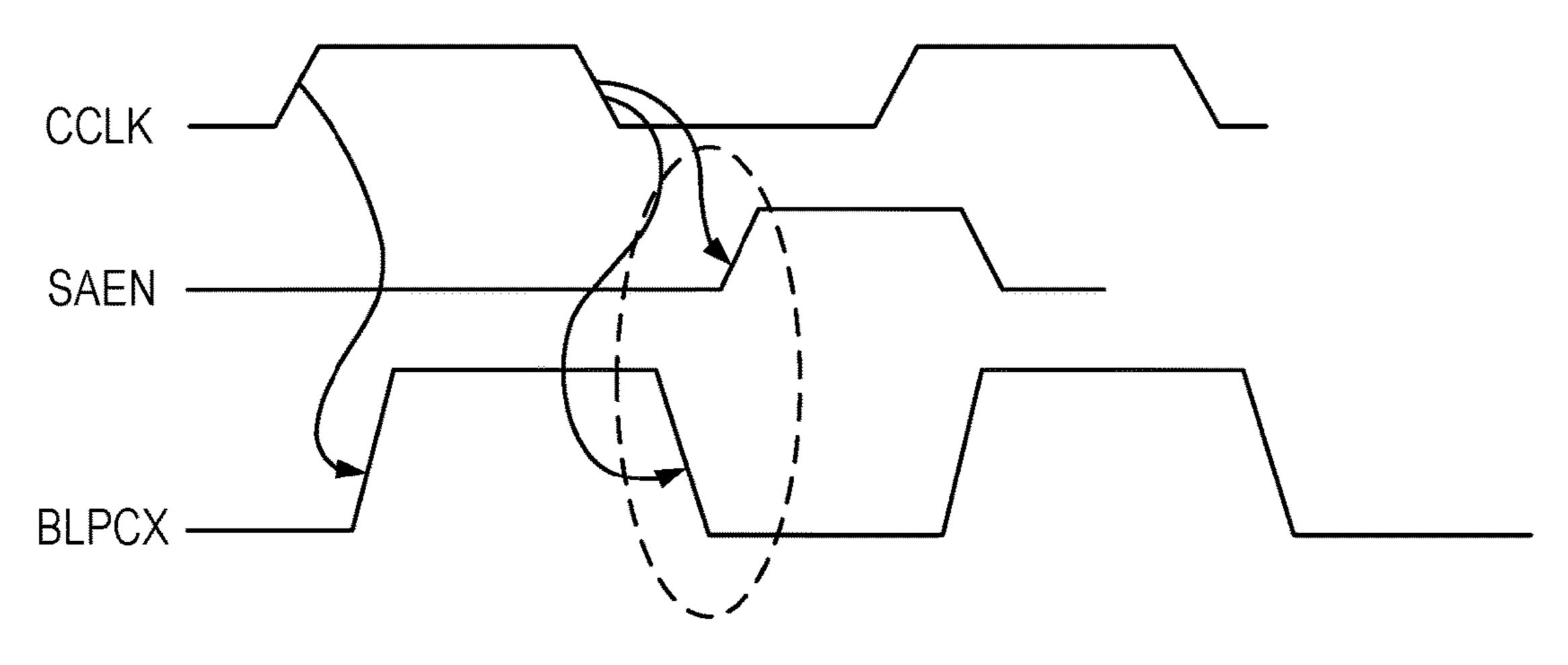
When VDD1>>VDD2 BLPCX turns on before SAEN creating a failure
