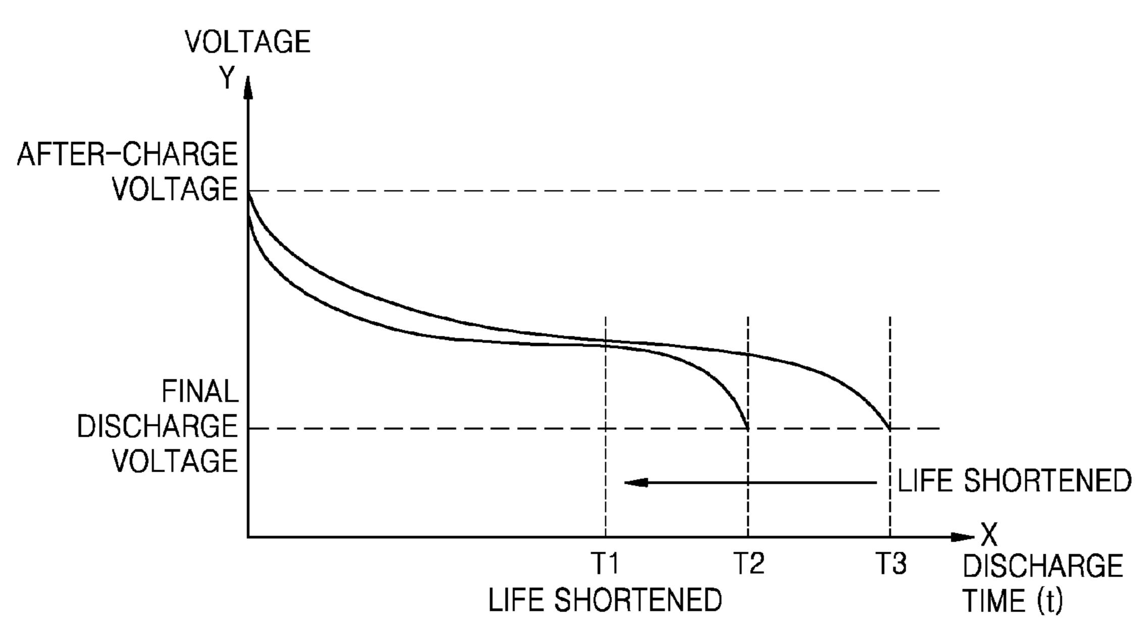
BATTERY OUTPUT VOLTAGE AT CONSTANT DISCHARGE CURRENT
