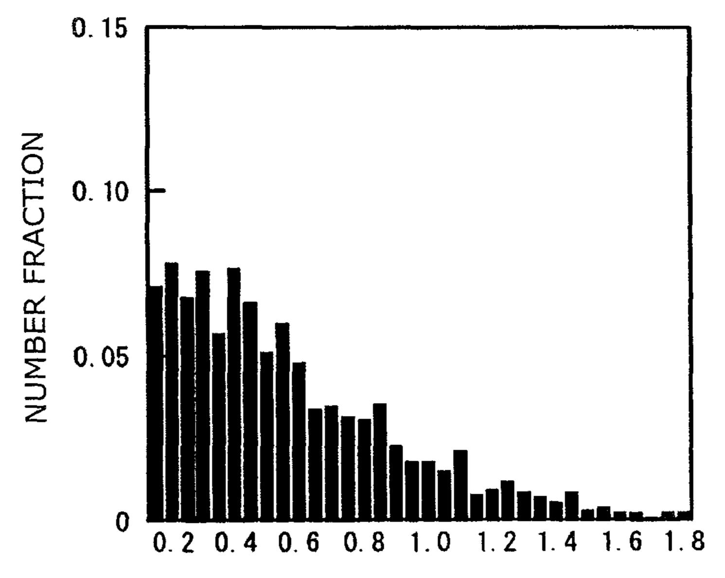
GRAIN SIZE OF RETAINED AUSTENITE GRAIN (µm)
