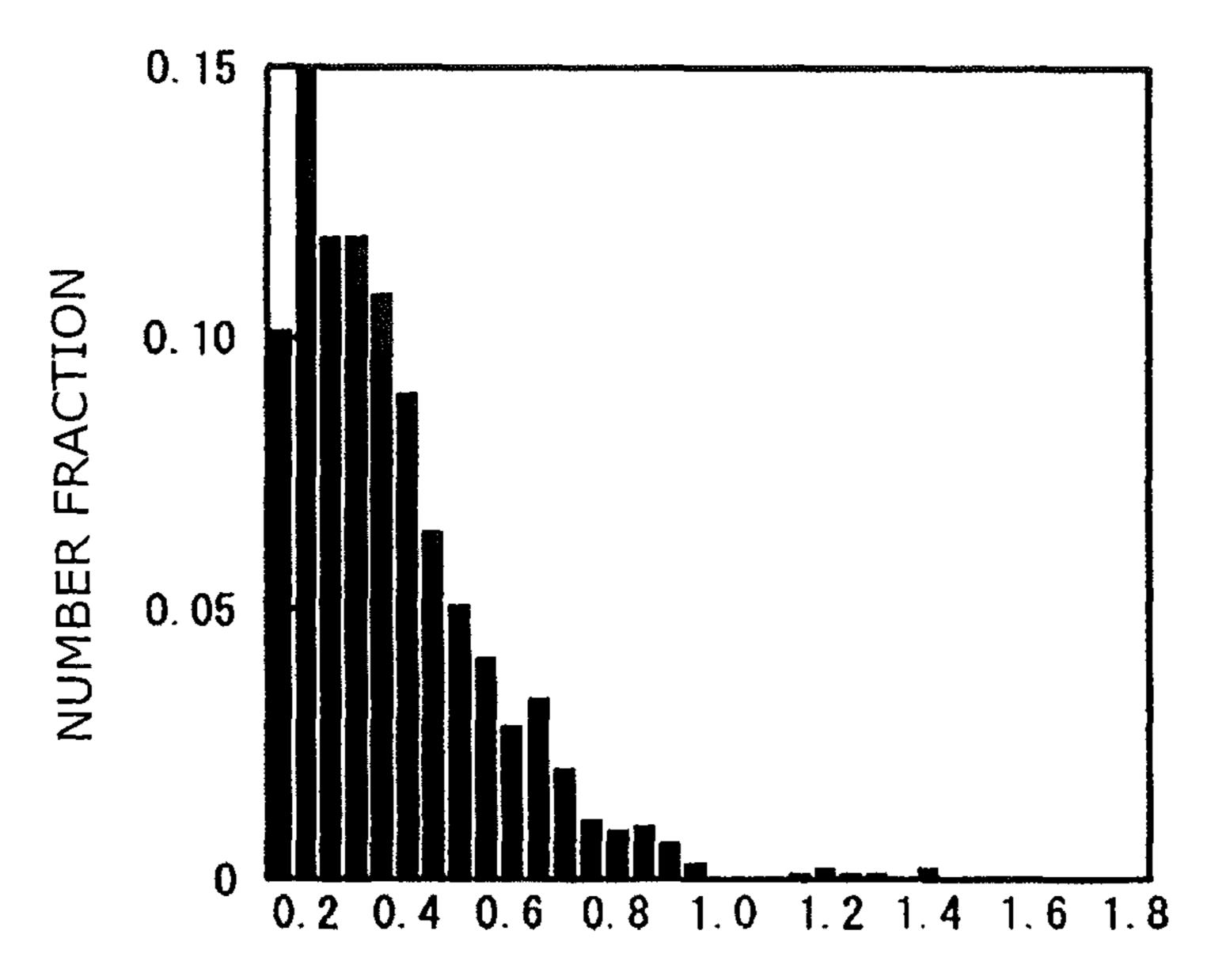
GRAIN SIZE OF RETAINED AUSTENITE GRAIN (µm)
