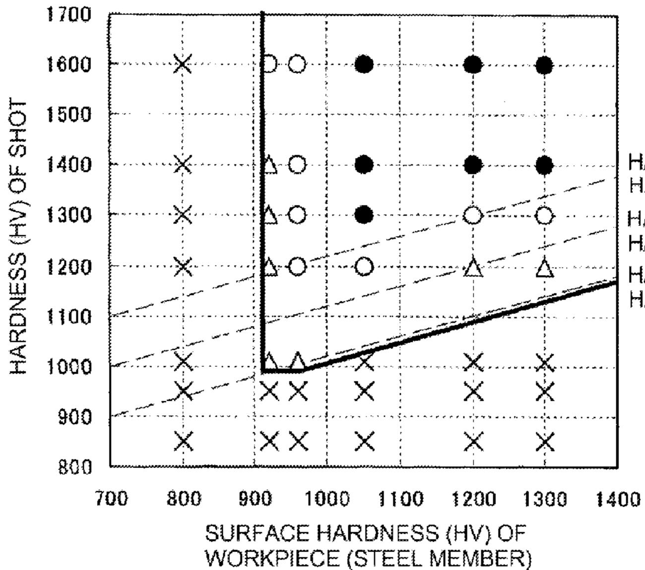
HARDNESS (HV) OF SHOT = 0.4 x SURFACE HARDNESS (HV) OF STEEL MEMBER + 820 HARDNESS (HV) OF SHOT = 0.4 x SURFACE HARDNESS (HV) OF STEEL MEMBER + 720 HARDNESS (HV) OF SHOT = 0.4 x SURFACE HARDNESS (HV) OF STEEL MEMBER + 620
