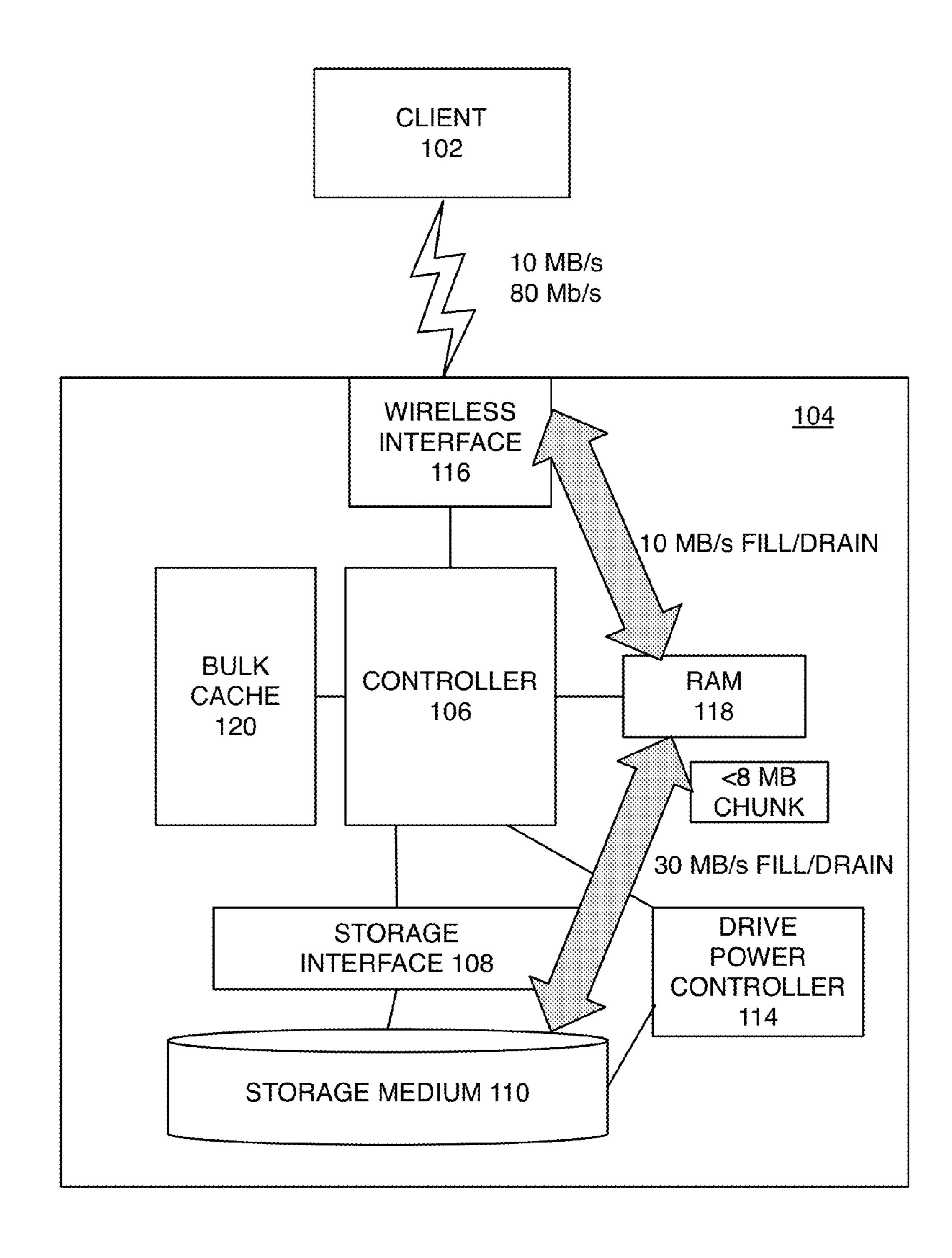
FIG. 2A SMALL BLOCK I/O READ/WRITE- NORMAL POWER CONSUMPTION
