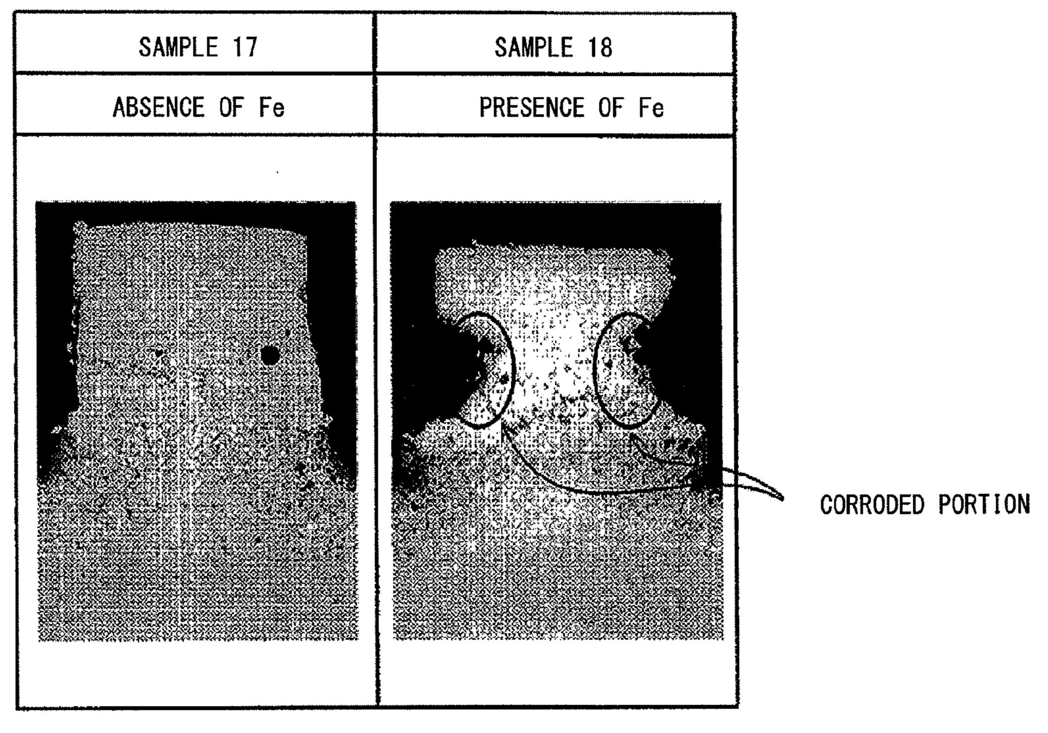
Ni=73wt%, Cr=25wt% $Al=0.05mg/mm^3$ ,  $Si=0.08mg/mm^3$
