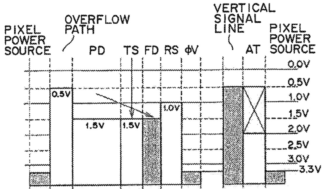
FIG. 5B  $t_4 < t < t_5$  SIGNAL LEVEL READ-OUT
