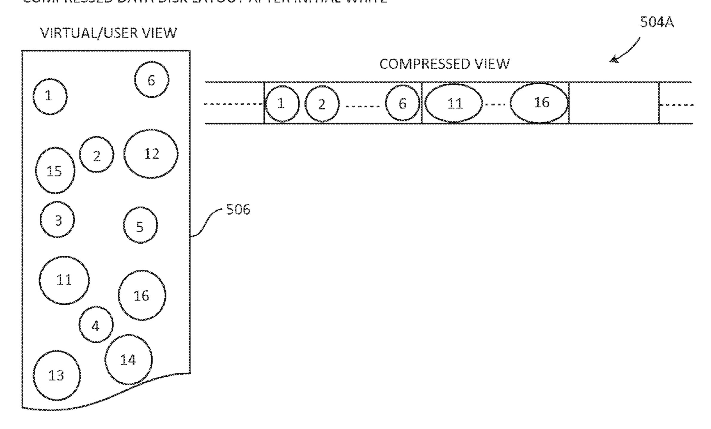
COMPRESSED DATA DISK LAYOUT AFTER BACKUP/MIRROR VIRTUAL/USER VIEW WILL STAY THE SAME, WHILE THE COMPRESSED VIEW APPEARS AS FOLLOWS:
