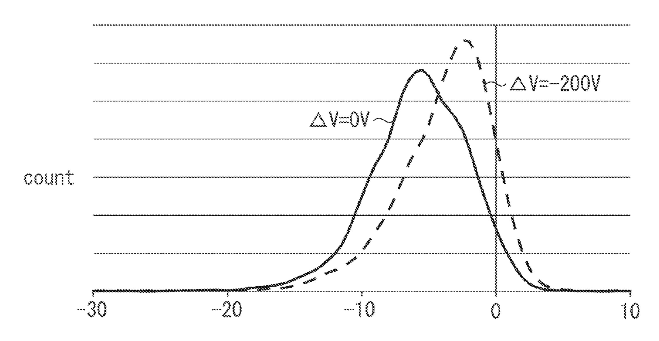
CHARGE AMOUNT DISTRIBUTION ON DEVELOPING ROLLER Q/M
