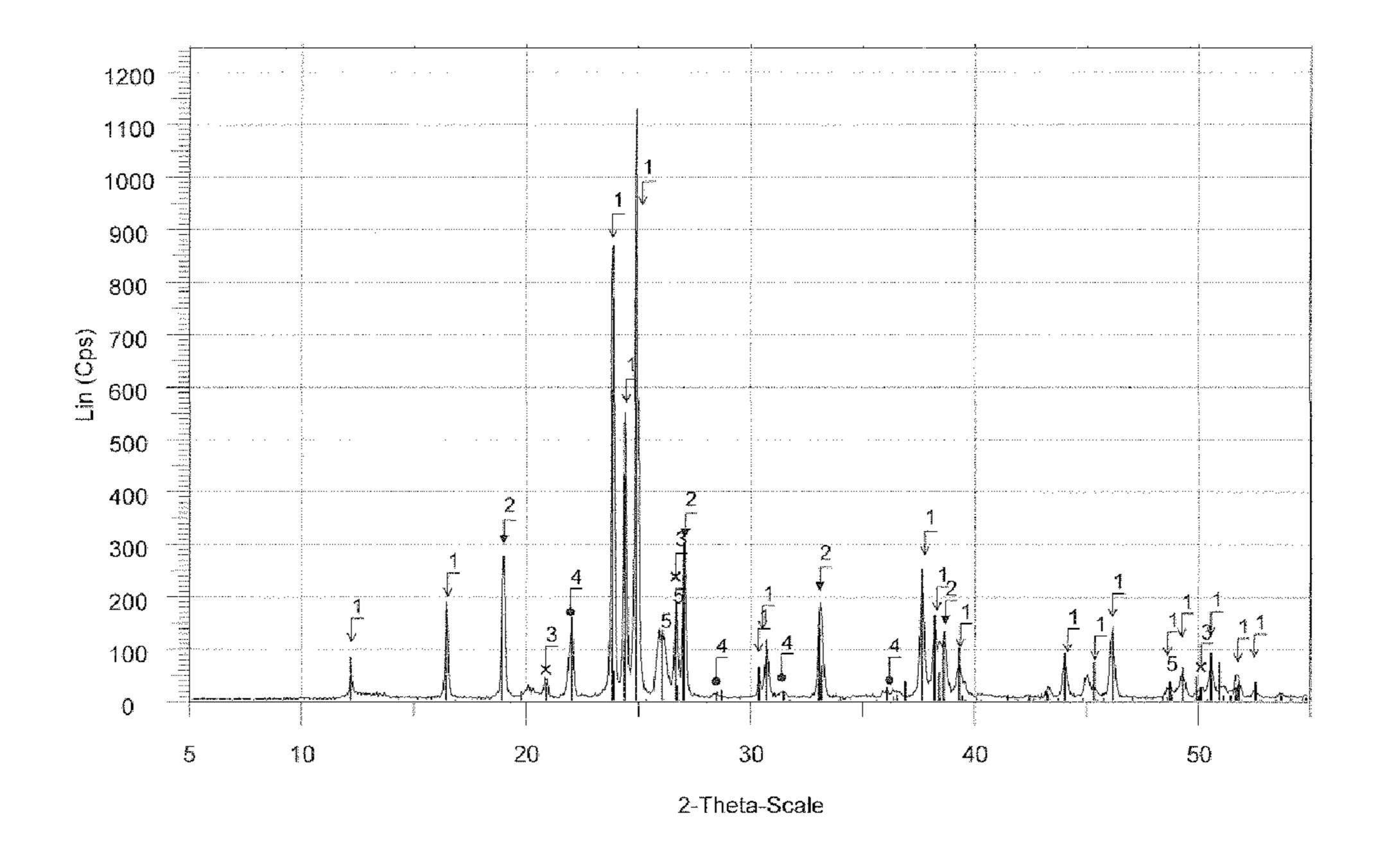
1 Lithium disilicate Li<sub>2</sub>Si<sub>2</sub>O<sub>5</sub>
