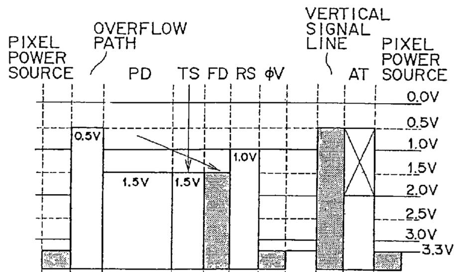
FIG. 5B  $t_4 < t < t_5$  SIGNAL LEVEL READ-OUT
