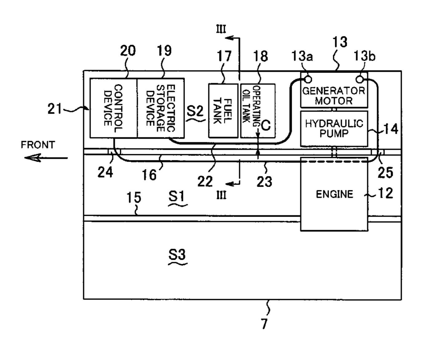
11 11 11 11 GENERATOR MOTOR HYDRAULIC PUMP 13 OPERATING OIL TANK FUEL TANK DEVICE FRON
