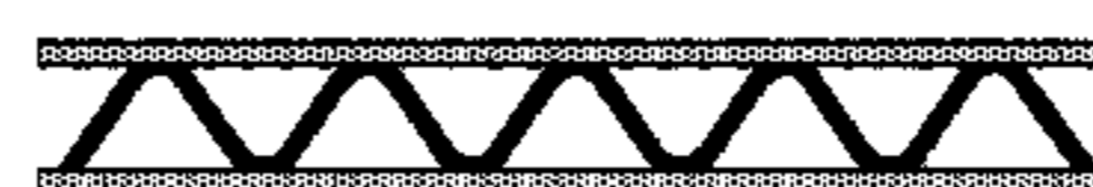
(d) Double plate-wave combination structure
