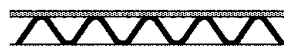
(d) Double plate-wave combination structure
