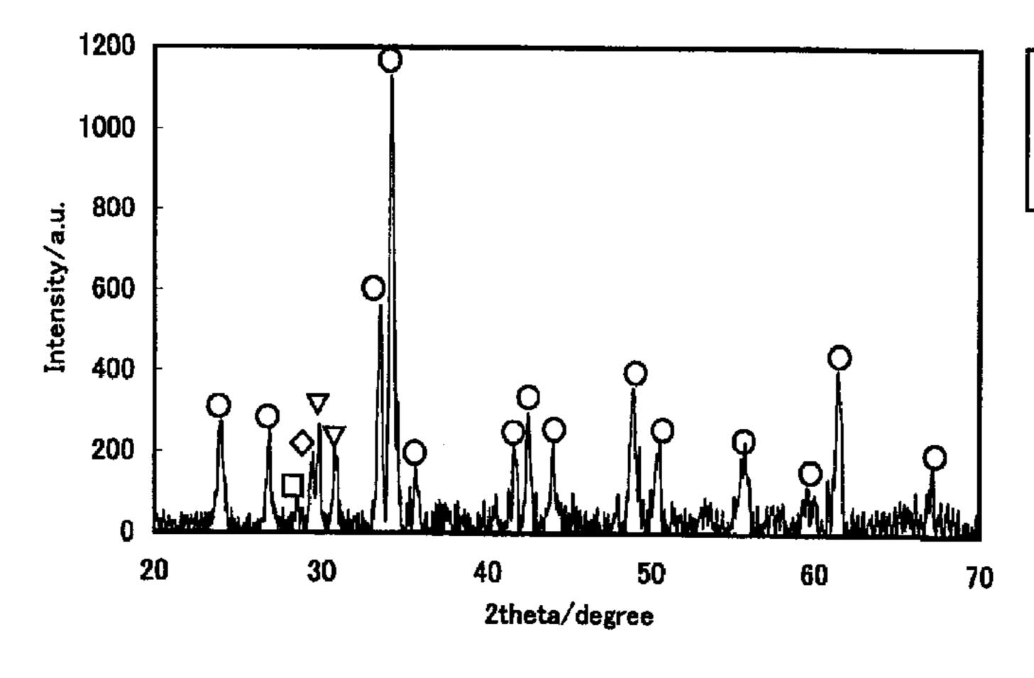
O:  $(RE2,Sr)(Al,M1)O_3$   $\nabla: RE1_4Al_2O_9$   $\diamondsuit: Yb_2O_3$  $\square: SrAl_2O_4$
