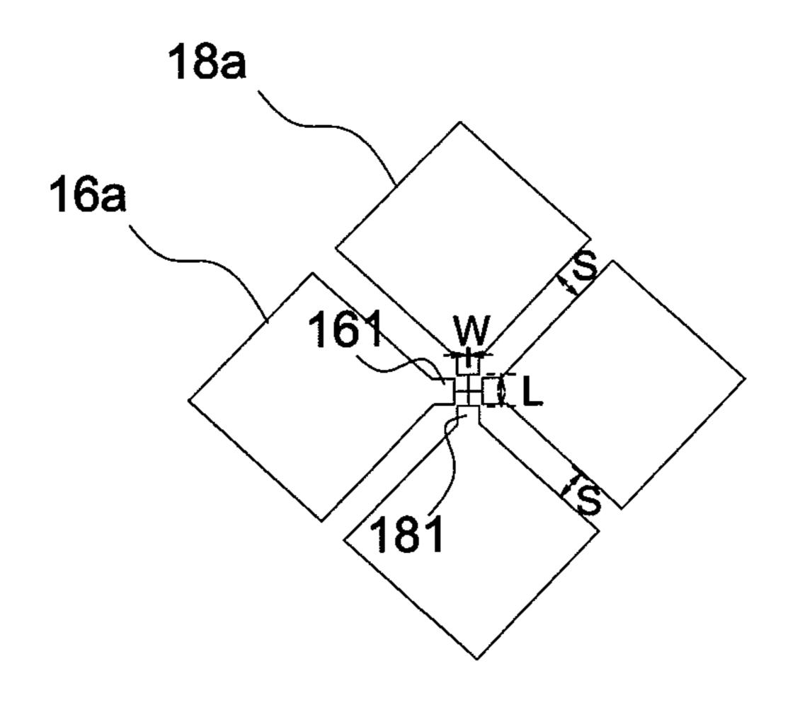
interval S:10-200 um length L:10-200 um width W:1-10 um thickness d: 0.1-10 um
