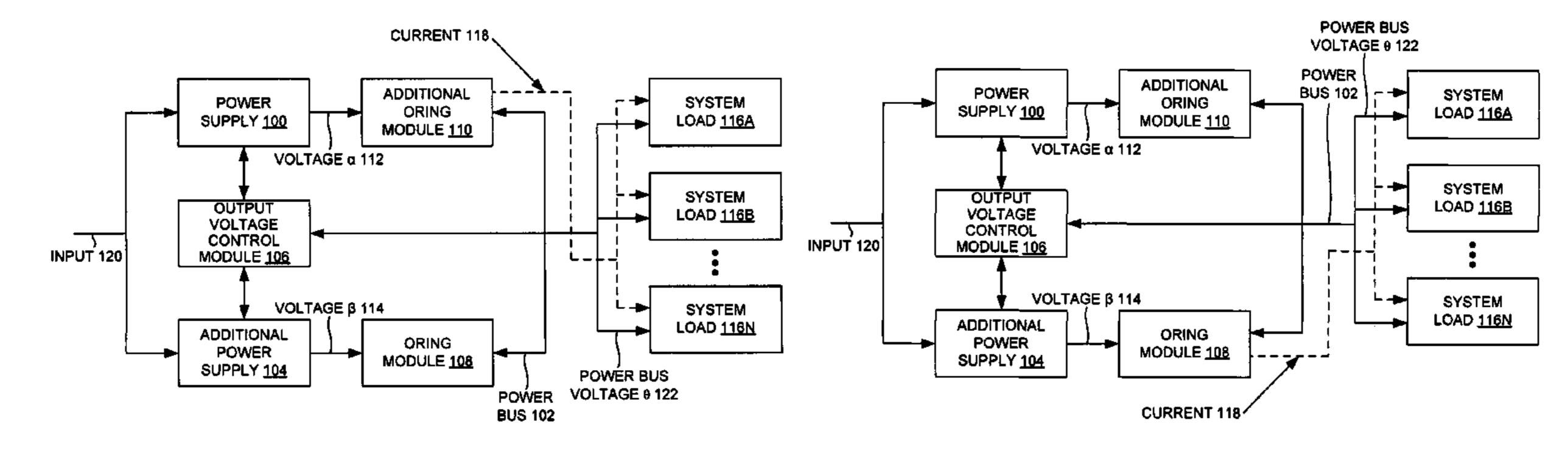
VOLTAGE α 112 > VOLTAGE β 114 VOLTAGE β 114 < POWER BUS VOLTAGE θ 122
