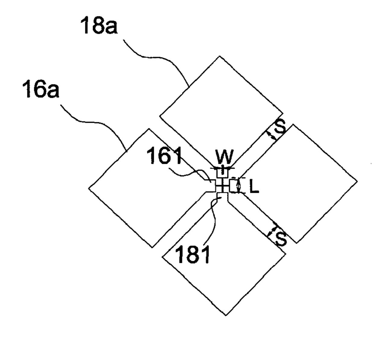
interval S:10-200 um length L:10-200 um width W:1-10 um thickness d: 0.1-10 um
