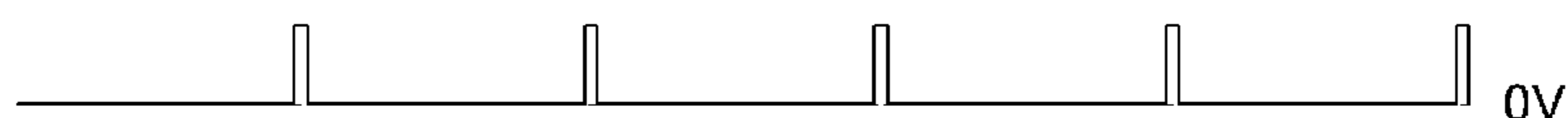
FIG. 8L ZVdt OUTPUT VOLTAGE
