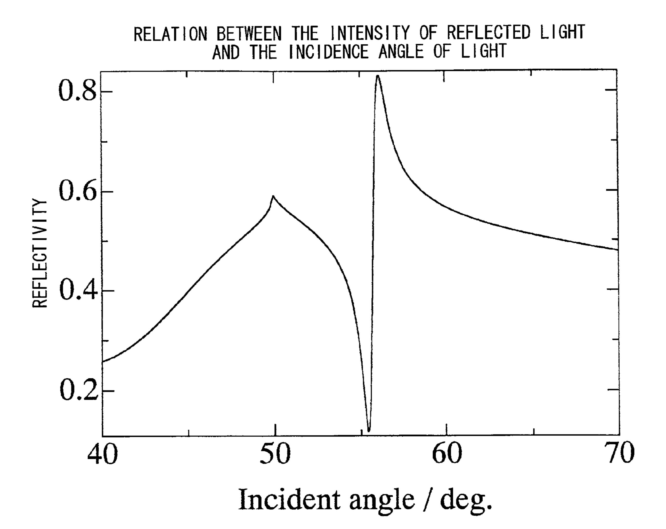
INCIDENT LIGHT: S-POLARIZED LIGHT OF 633 nm
