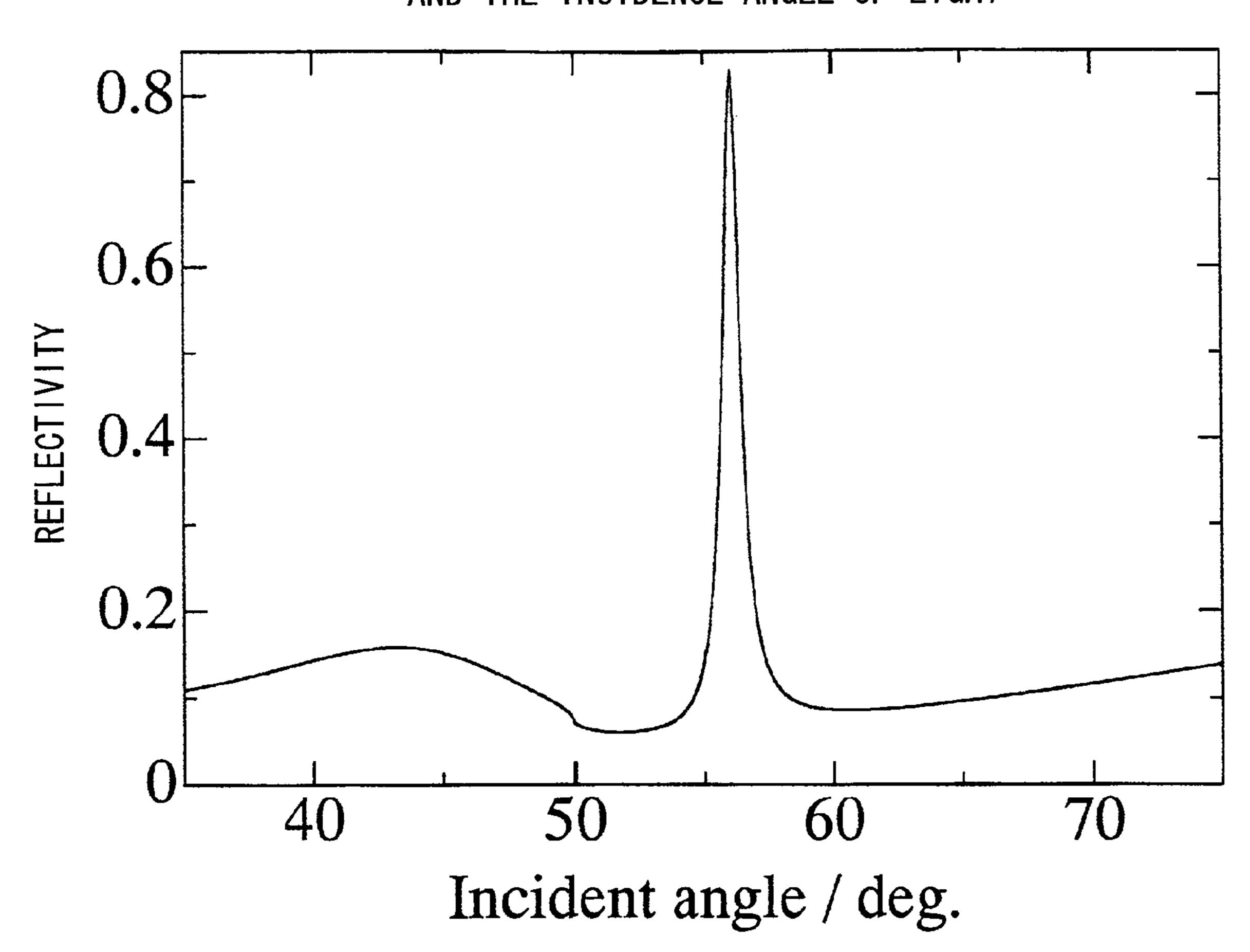
INCIDENT LIGHT: S-POLARIZED LIGHT OF 633 nm
