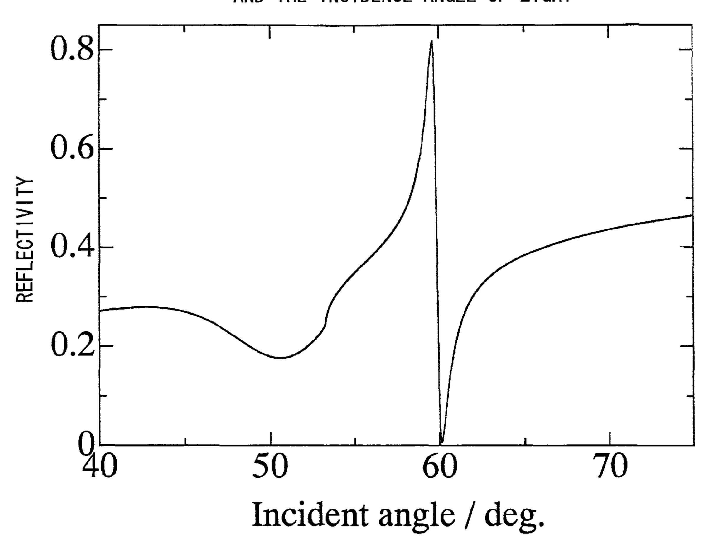
INCIDENT LIGHT: S-POLARIZED LIGHT OF 300 nm
