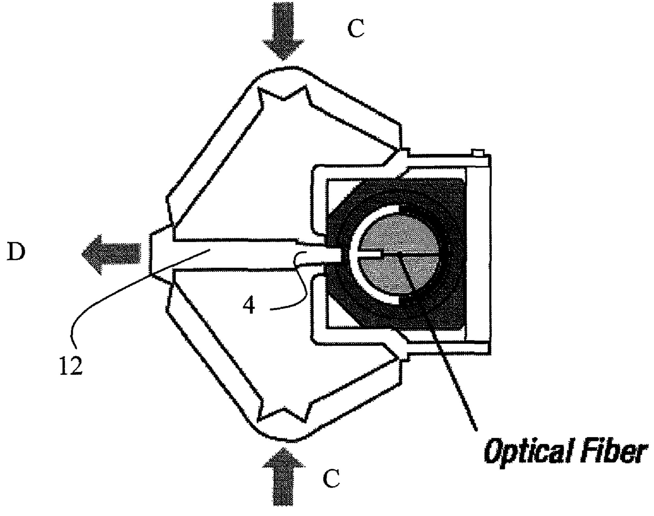
PUSH HERE TO DISENGAGE WEDGE / LOCK FIBER
