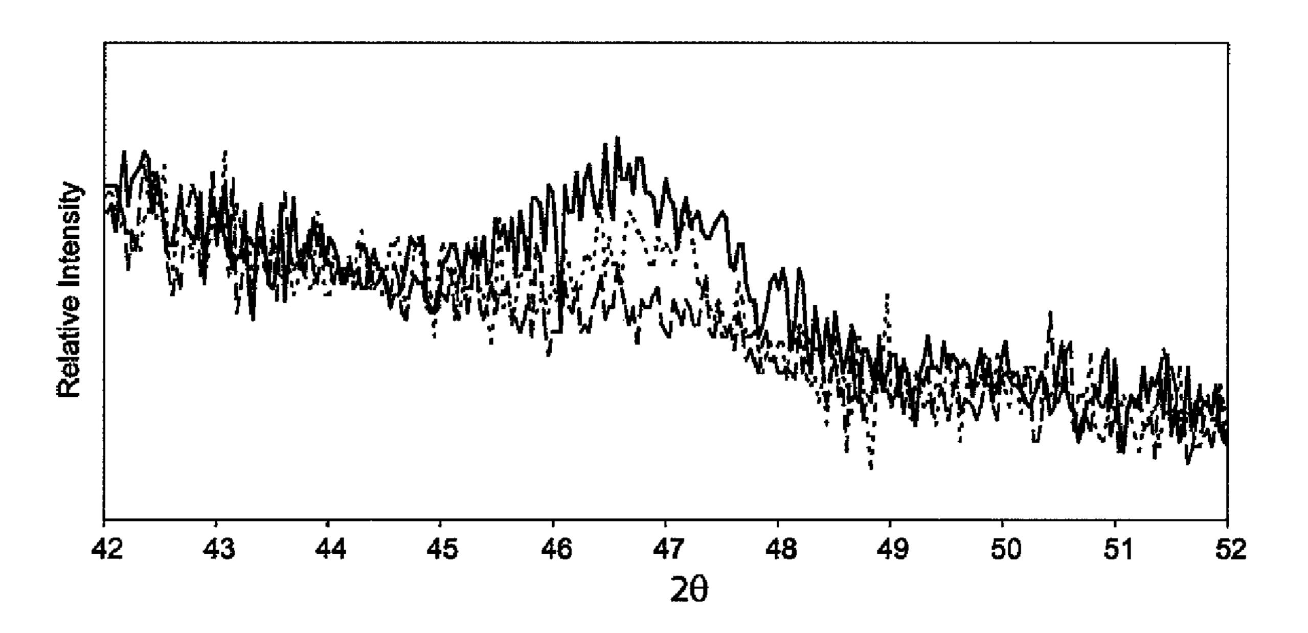
PXRD pattern of the (111) peak for the 0.55 (--), 1.10 (---), and 1.82 (--) wt% Pd(0) colloidal aluminosilicate particles after reduction.
