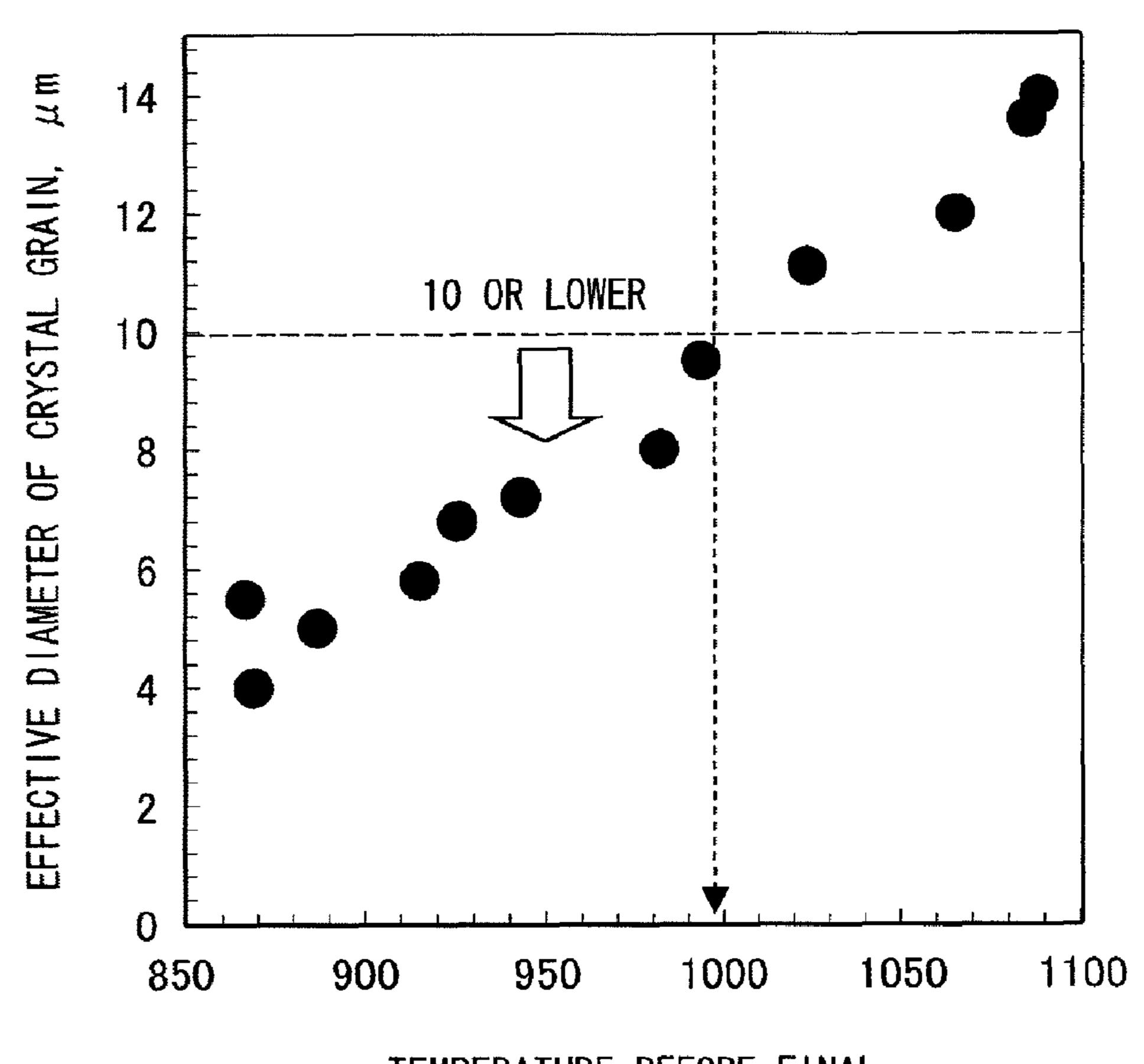
TEMPERATURE BEFORE FINAL ROLLING PASS IN SECOND HOT ROLLING, °C
