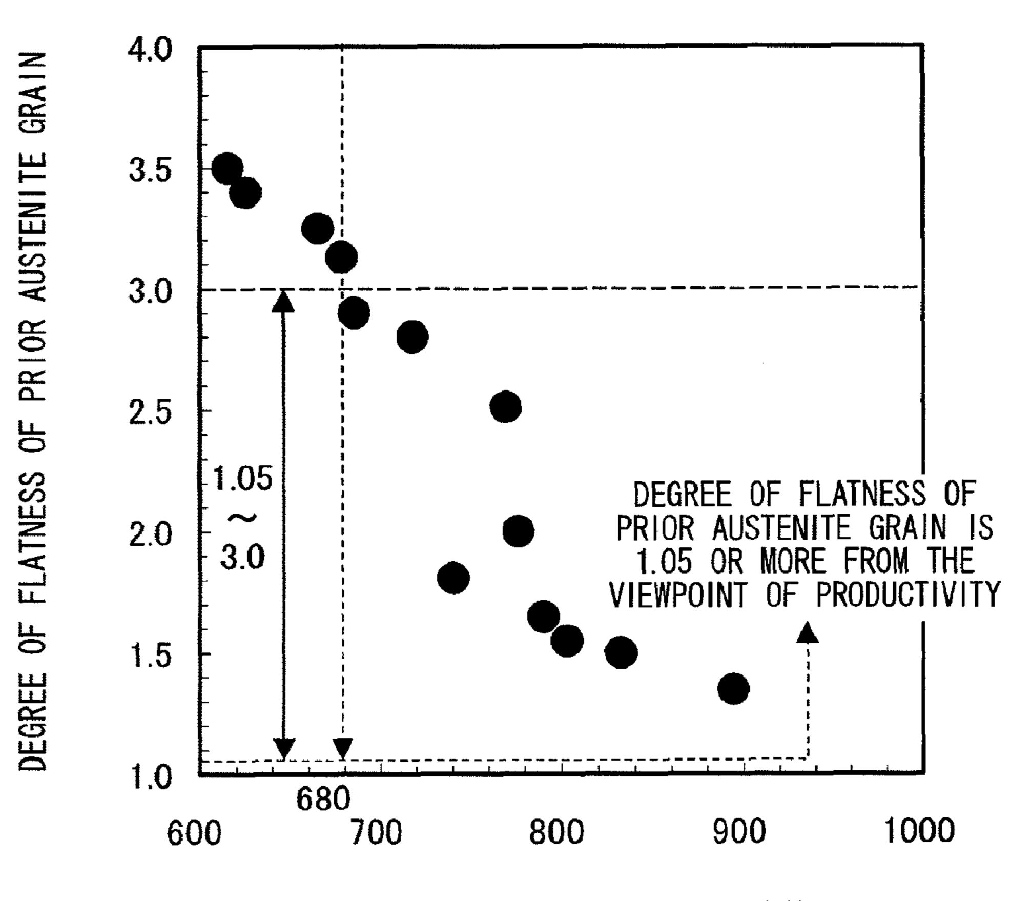
TEMPERATURE BEFORE FINAL ROLLING PASS IN SECOND HOT ROLLING, °C
