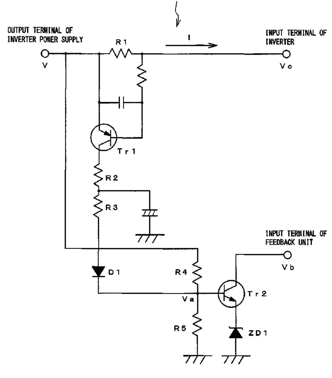
STABILIZIN **FEEDBACK** UNIT Ω POWER POWER SUPPLY INVERTER
