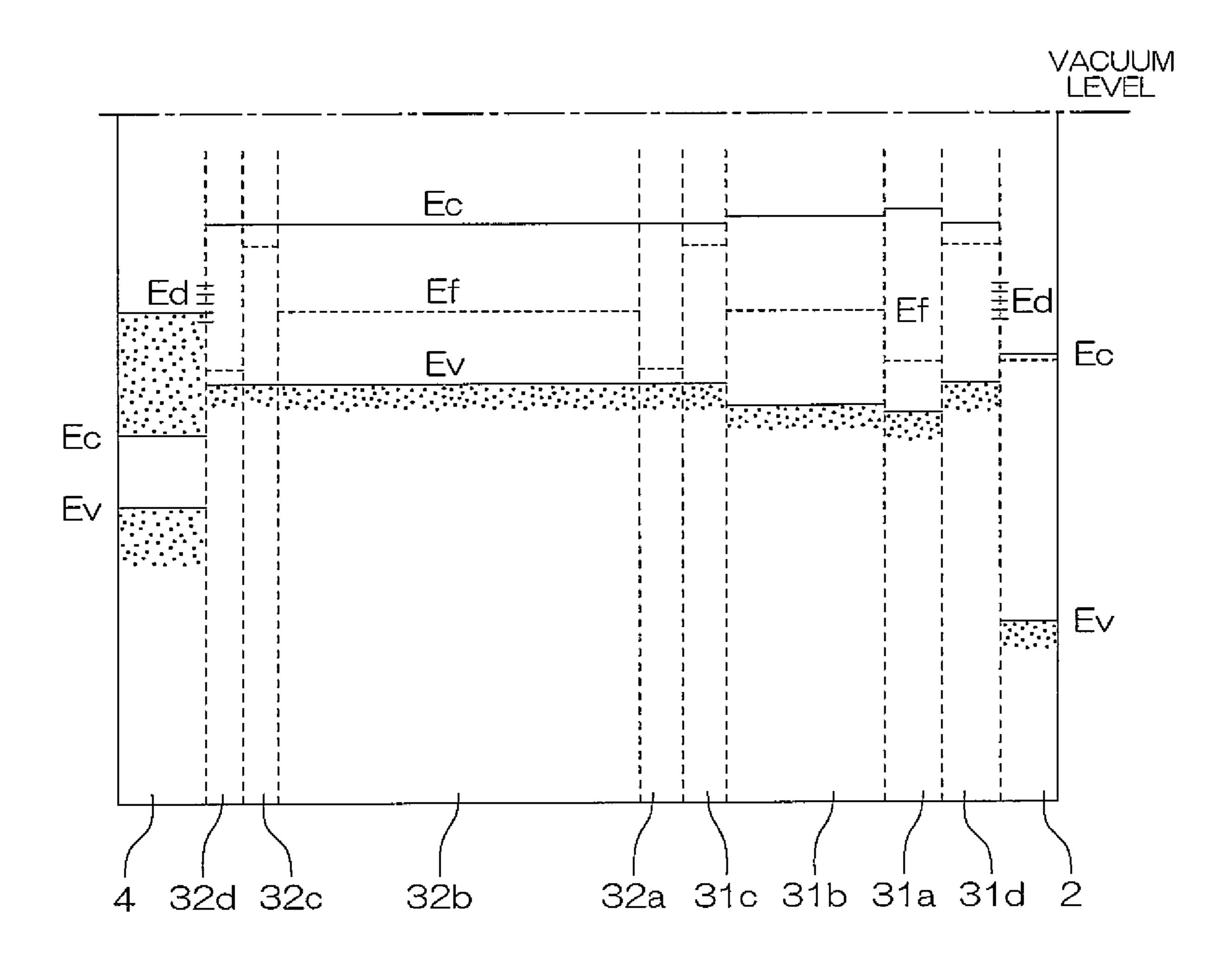
2: TCO(TRANSPARENT CONDUCTIVE OXIDE) 31d:  $\mu$ c-Si:H n TYPE 31a: a-SiC:H p TYPE 31b: a-Si:H i TYPE 31c:  $\mu$ c-Si:H n TYPE
