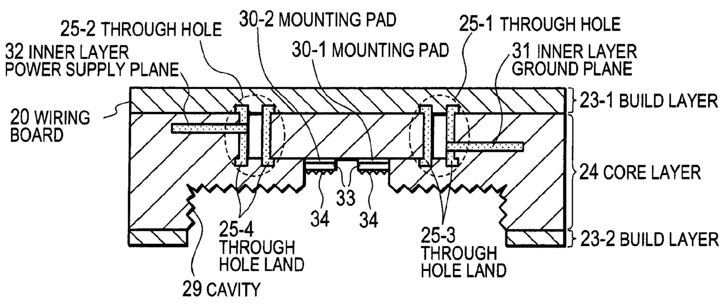
33: NON-ELECTROLYTIC NICKEL PLATING 34: NON-ELECTROLYTIC GOLD PLATING
