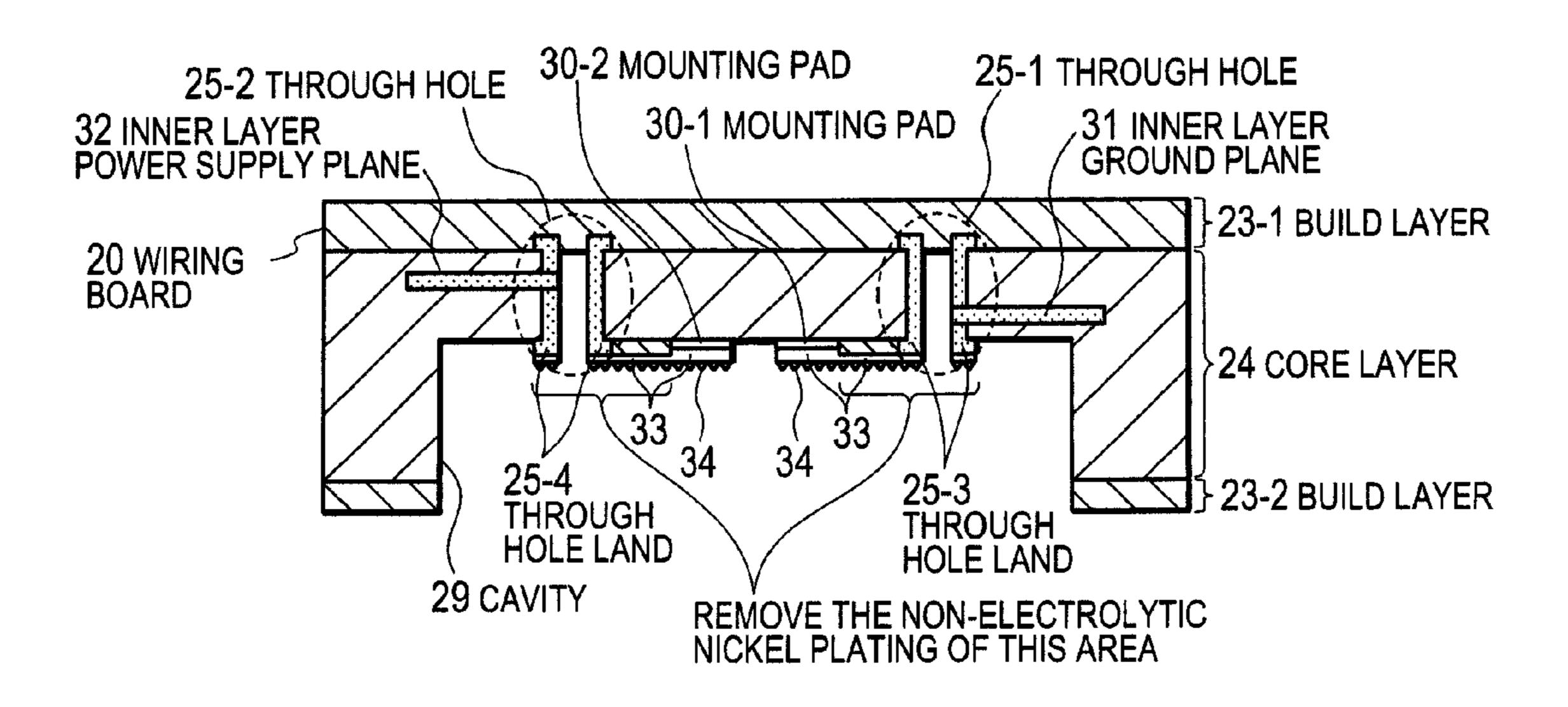
33: NON-ELECTROLYTIC NICKEL PLATING 34: NON-ELECTROLYTIC GOLD PLATING
