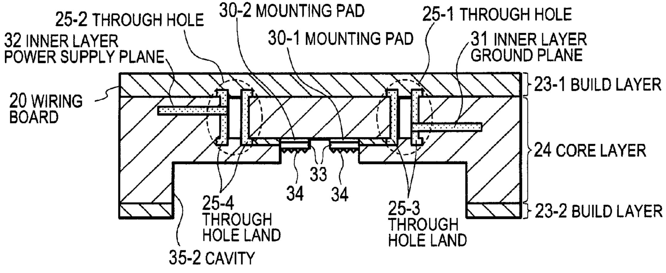
33: NON-ELECTROLYTIC NICKEL PLATING 34: NON-ELECTROLYTIC GOLD PLATING
