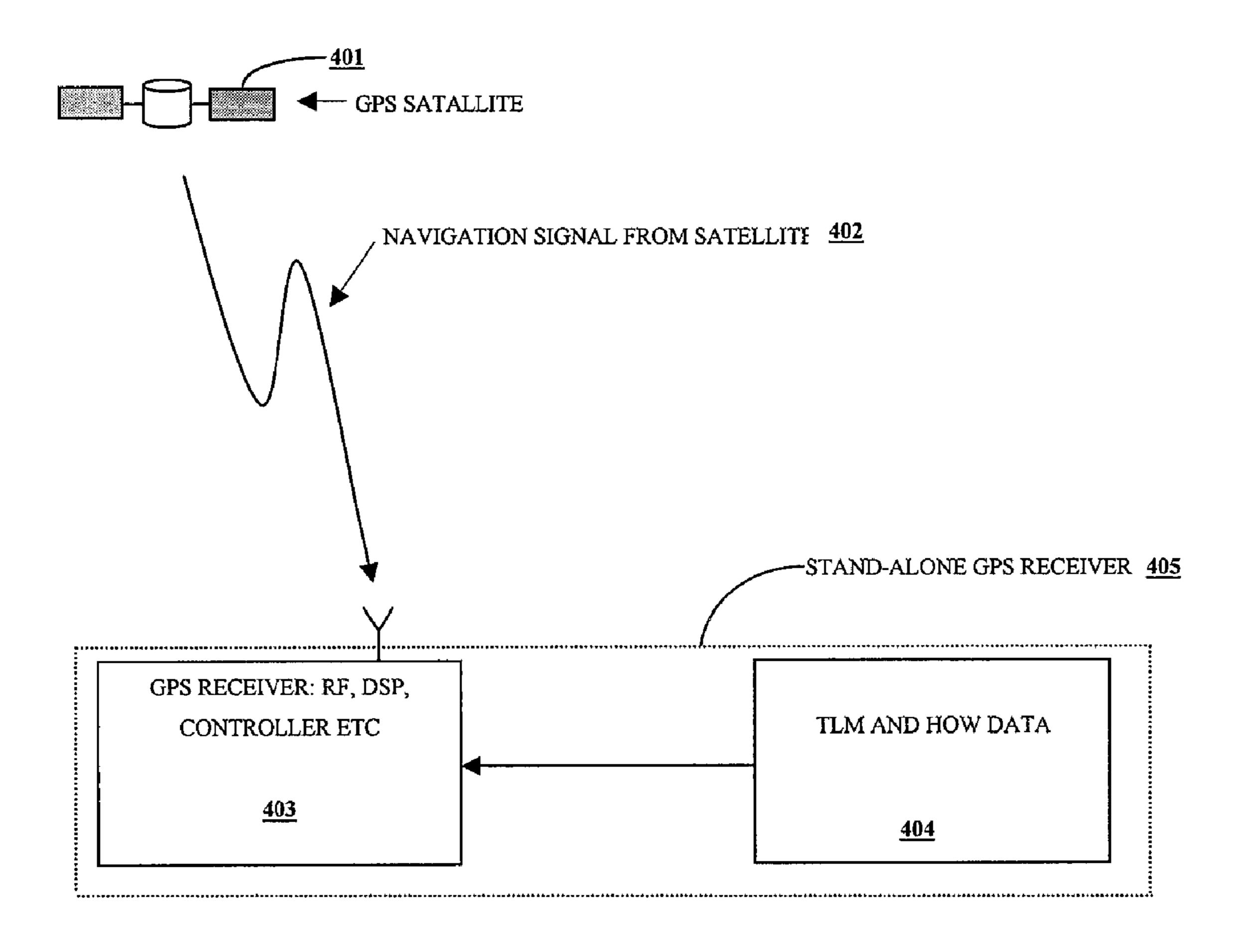
FIG 4. NAVIGATION RECEIVER SYSTEM
