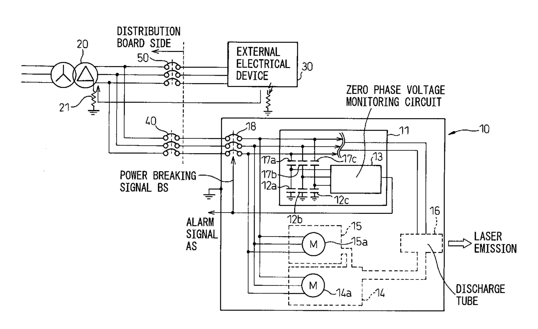
9----ZERO PHASE MONITORING EXTERNAL ELECTRIC DEVICE 9 ALARM SIGNAL AS BREAKING. BS DISTRIBUTION BOARD SIDE POWER SIGNAL
