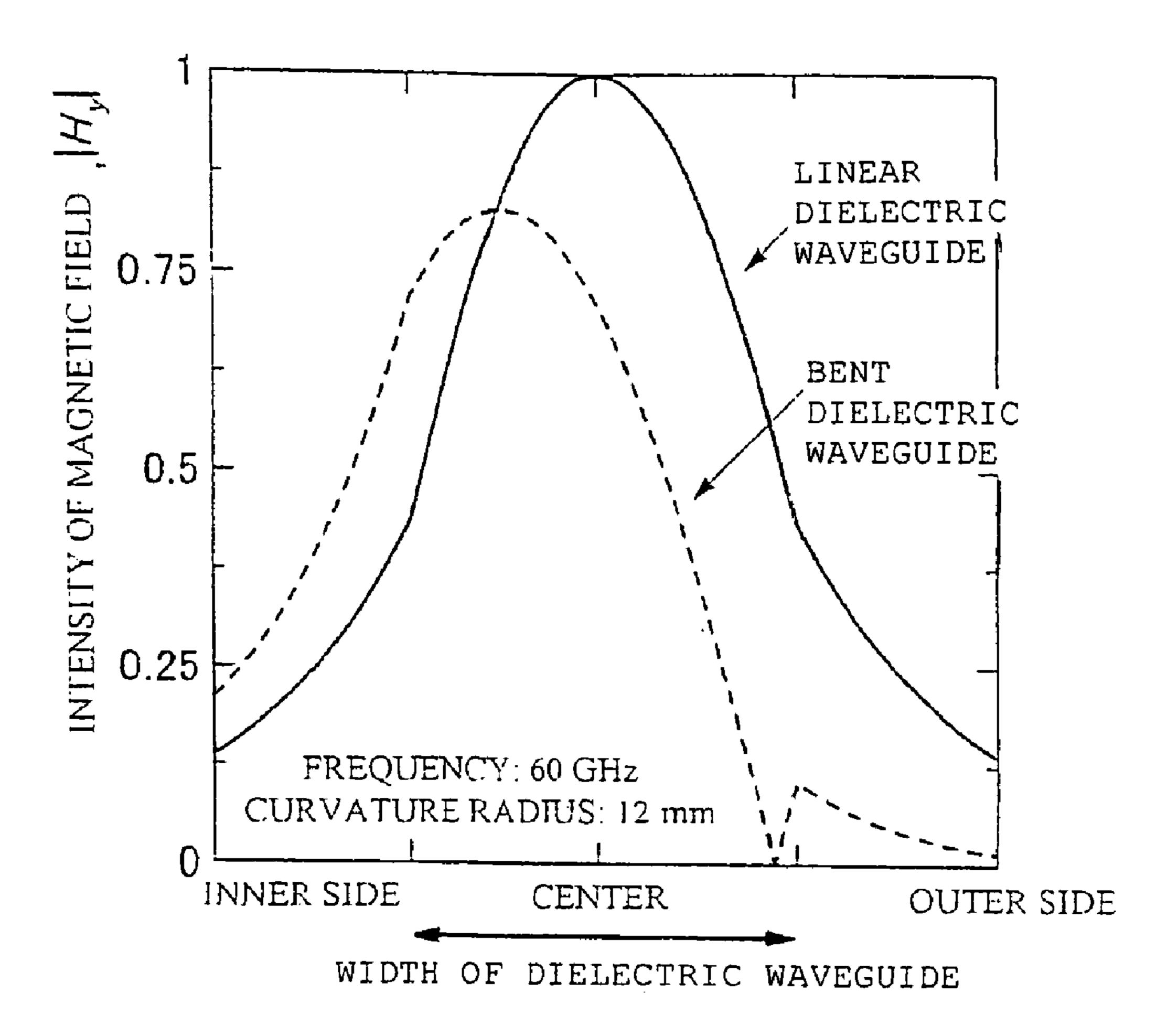
DIELECTRIC WAVEGUIDE RELATIVE DIELECTRIC CONSTANT: 2.04
