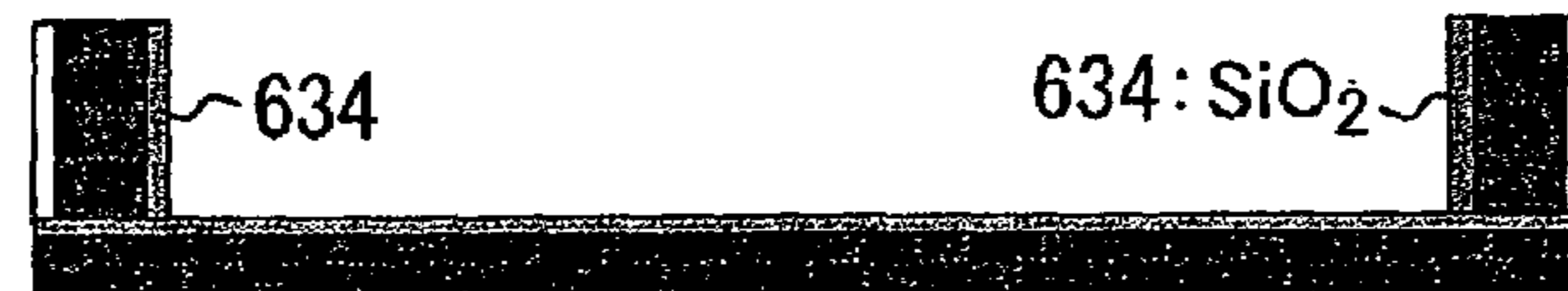
Fig. 16(d) SiO2 DEPOSITION, ETCHING
