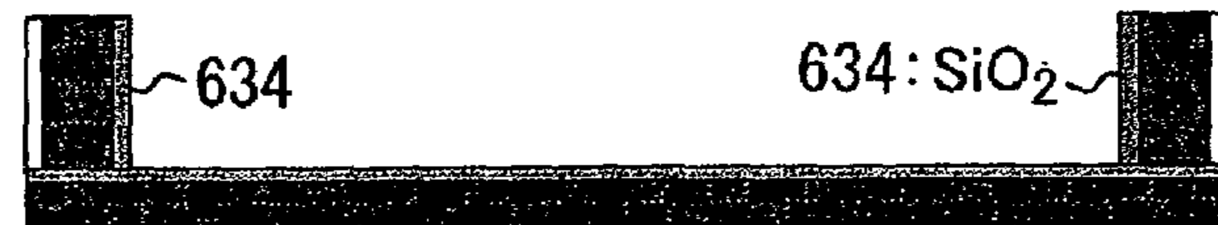
Fig. 16(d) SiO2 DEPOSITION, ETCHING
