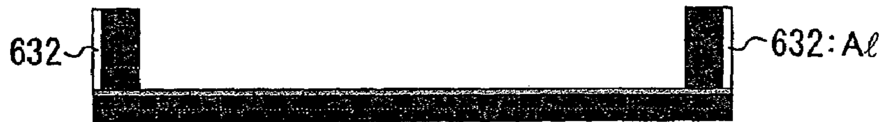
Fig. 16(c) Al VAPOR DEPOSITION, ETCHING
