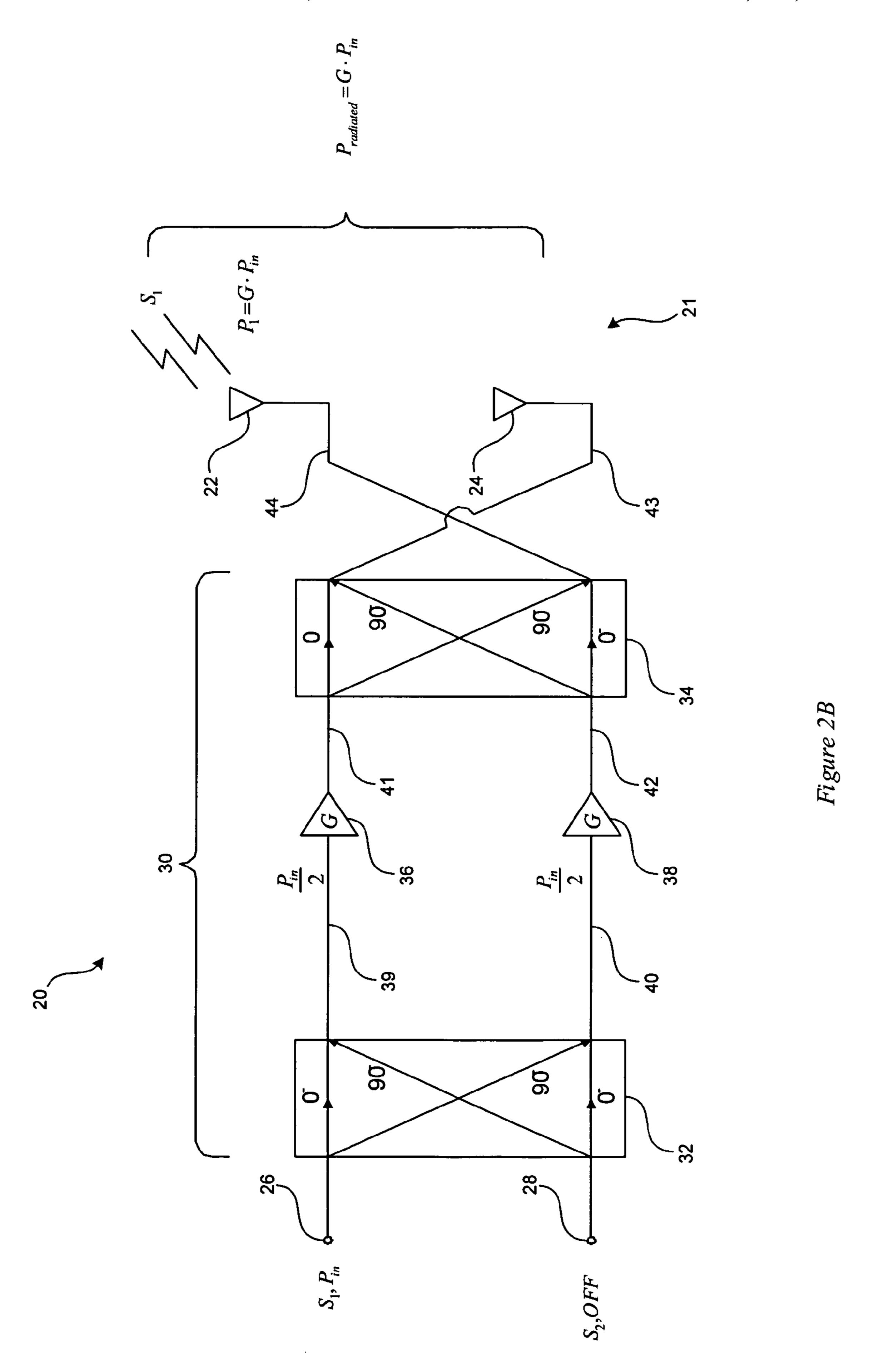
TRANSMIT SYSTEM EMPLOYING AN ANTENNA AND BALANCED AMPLIFIER ARCHITECTURE WHICH PROVIDES POWER AMPLIFIER LOAD BALANCING INDEPENDENT OF SINGLE OR DUAL SIGNAL OPERATION OF THE TRANSMITTER
