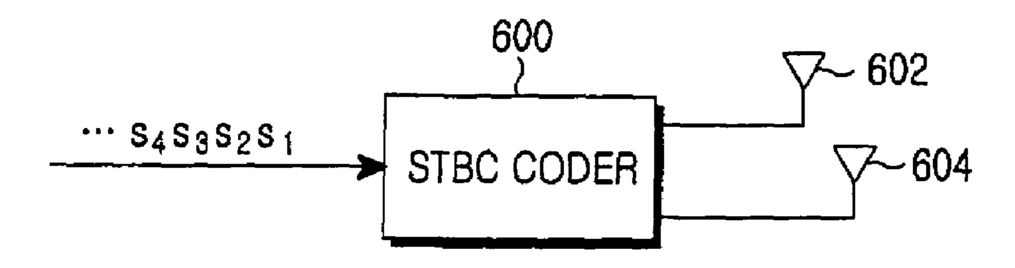
$$C = \begin{bmatrix} as_1 + jbs_4 & bs_2 + as_3 \\ as_2 - bs_3 & jbs_1 + as_4 \end{bmatrix} = \begin{bmatrix} c_1 & c_3 \\ c_2 & c_4 \end{bmatrix}$$
