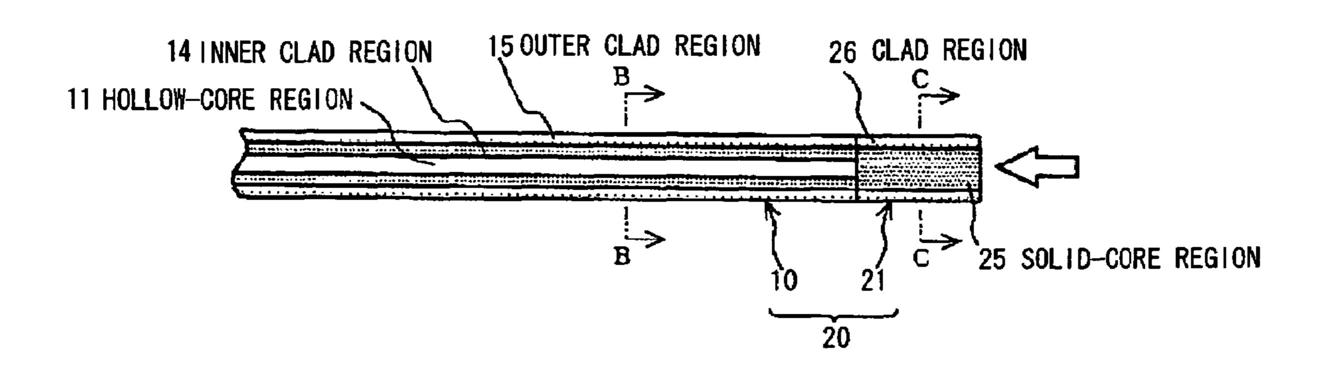
20 LASER ENERGY TRANSMISSION OPTICAL FIBER 10: OPTICAL FIBER MAIN BODY 21: SOLID-CORE TYPE OPTICAL FIBER
