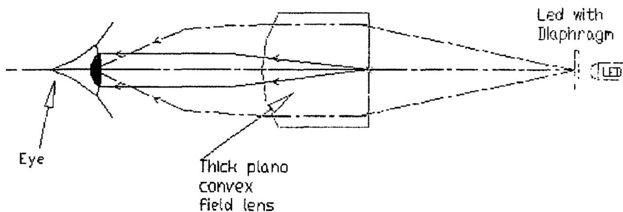
**FIGURE 7: COMPLETE OPTICAL RAY PATH INSIDE THE EYEPIECE SHOWN IN FIGURE 4(A)**
