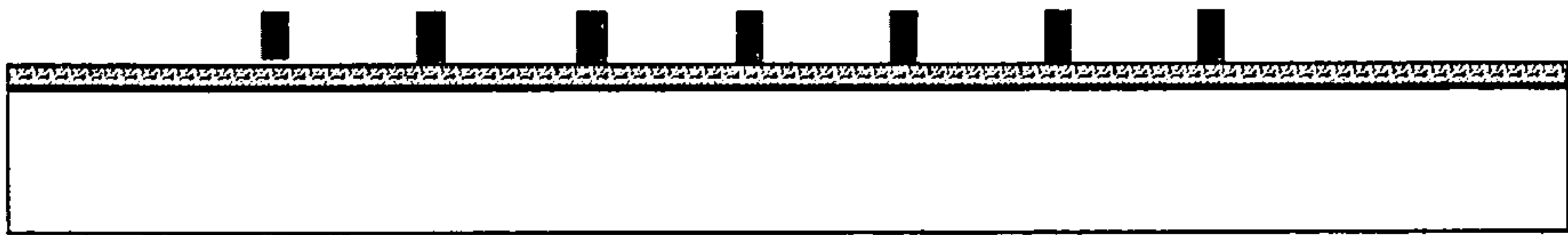
Fig. 23 Remove seed layer
