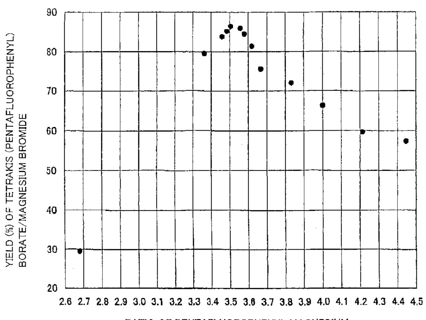
RATIO OF PENTAFLUOROPHENYL MAGNESIUM BROMIDE AND BORON TRICHLORIDE
