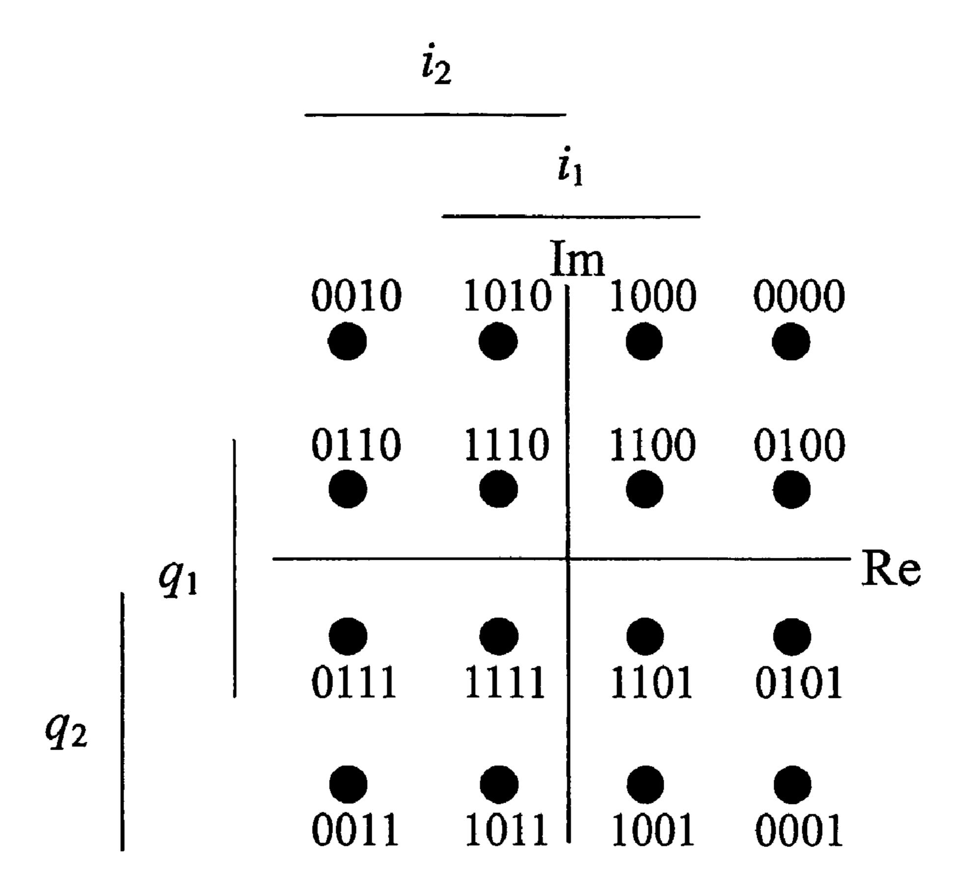
Mapping 2 (bit-mapping order:  $i_1q_1i_2q_2$ )
