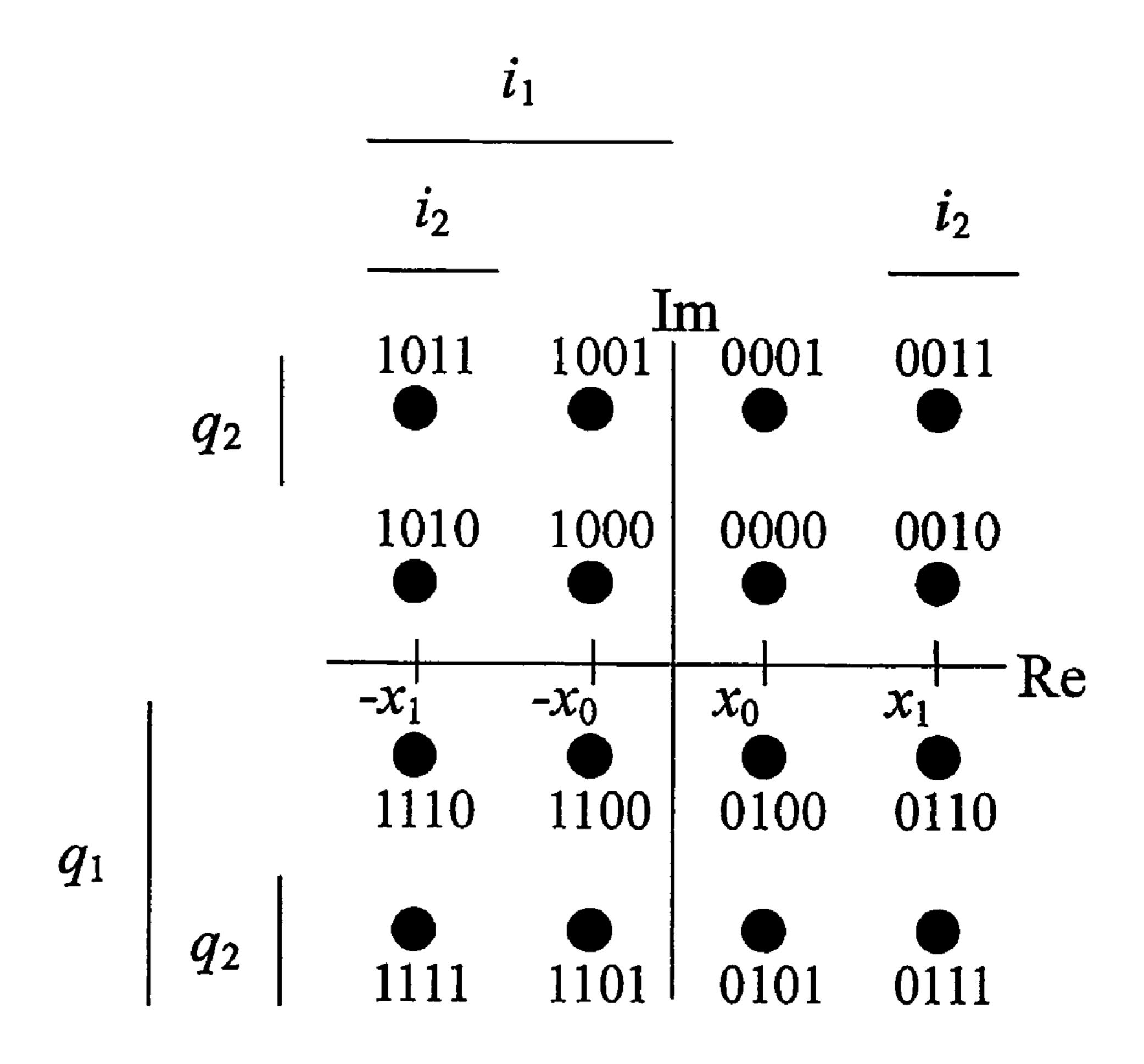
Mapping 1 (bit-mapping order:  $i_1q_1i_2q_2$ )
