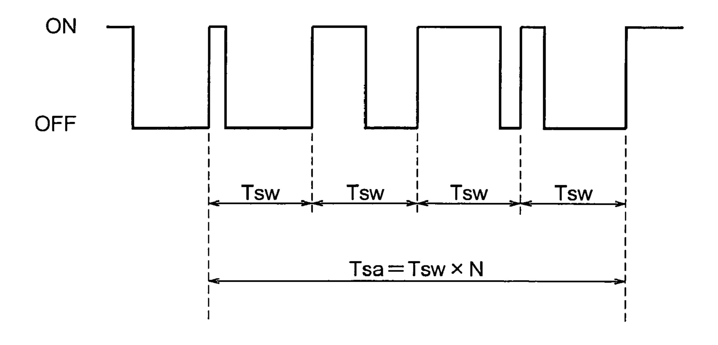
Tsw: FIELD SWITCH CYCLE TSa: SAMPLING CYCLE
