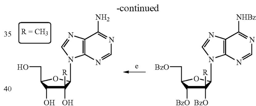
(a) Dess-Martin periodinane; (b) MeMgBr/TiCl<sub>4</sub>; (c) BzCl, DMAP, Et<sub>3</sub>N; (d) bis(trimethylsilyl)acetamide, N<sup>6</sup>-benzoyl adenine, TMSOTf; (e) NH<sub>3</sub>/MeOH
