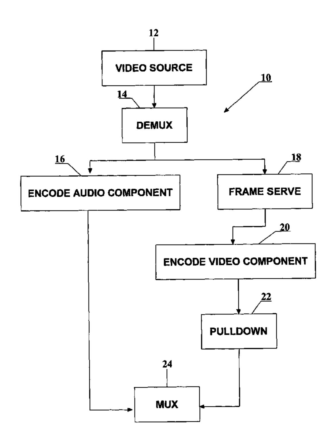
Fig. 1 **VIDEO SOURCE** <u>10</u> **DEMUX** FRAME SERVE ENCODE AUDIO COMPONENT ENCODE VIDEO COMPONENT PULLDOWN MUX
