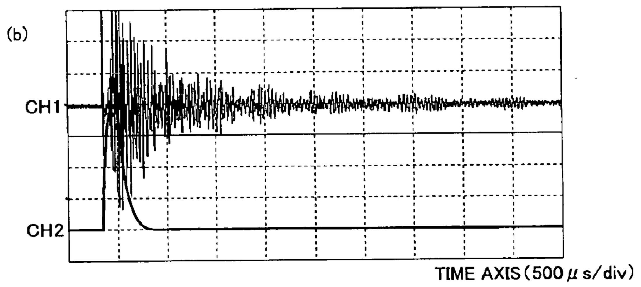
CH1 WAVEFORM RECEIVED BY THE AE SENSOR Gain 40+10dB (200mV/div)
