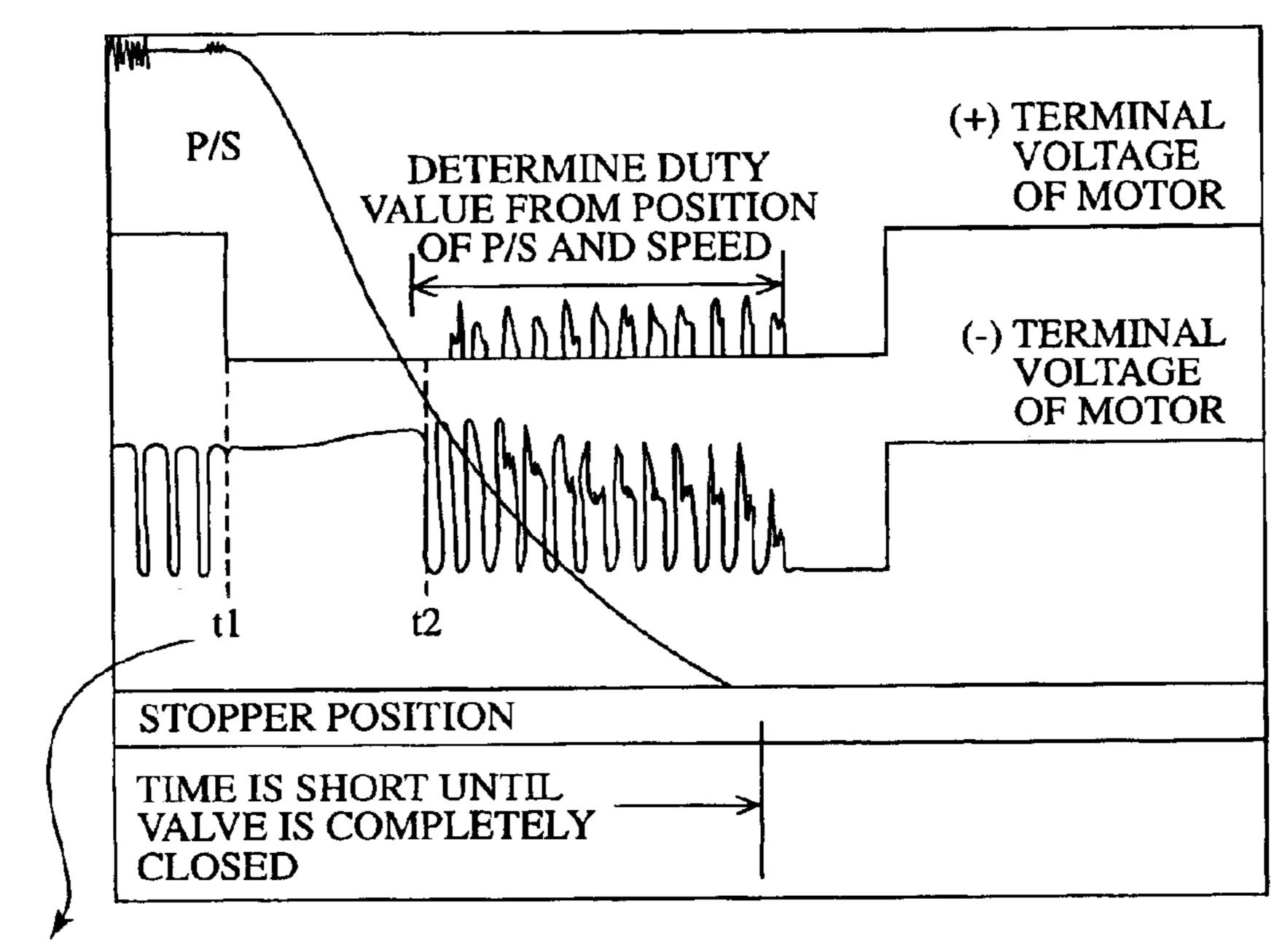
POSITION WHERE VALVE IS COMPLETELY CLOSED
