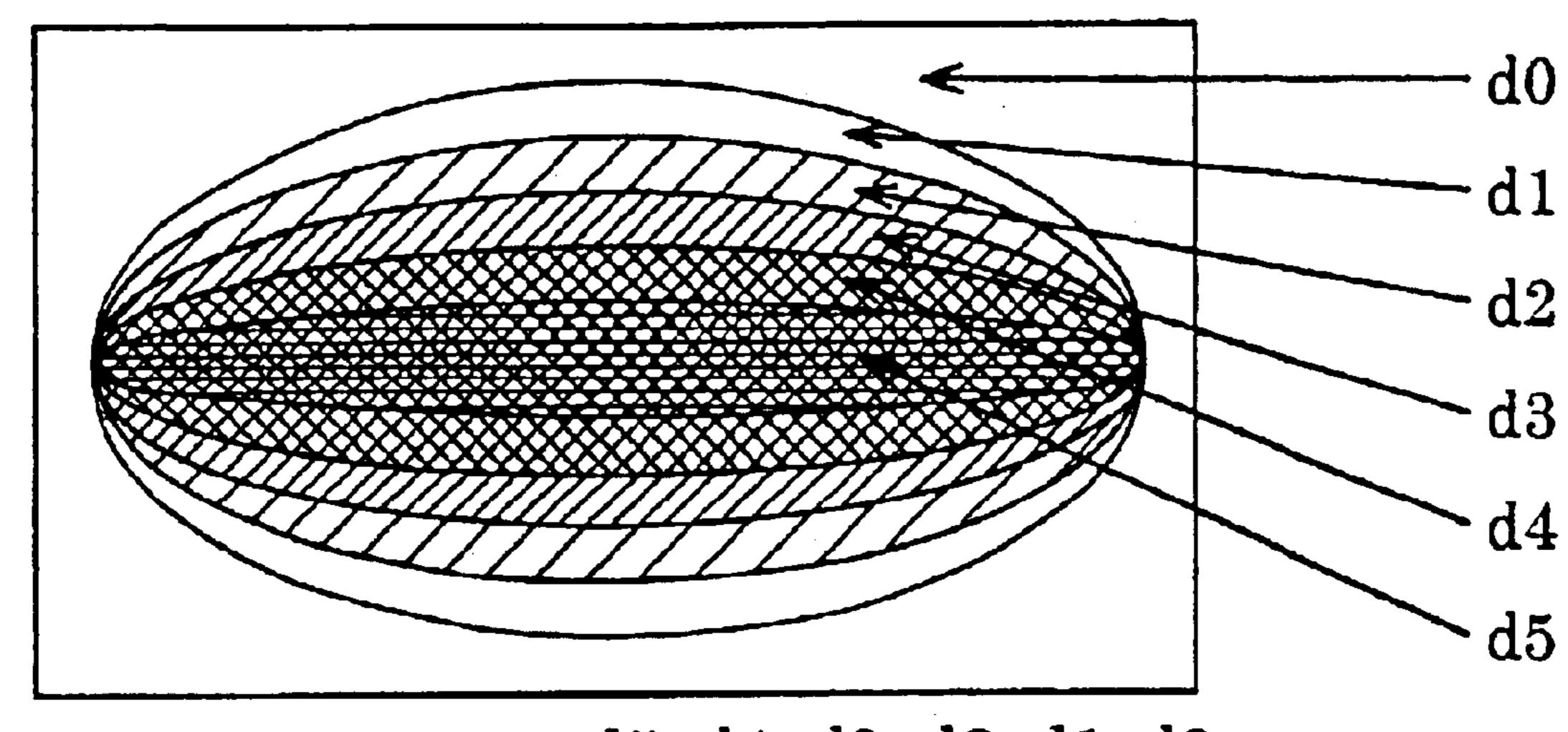
FILM THICKNESS: d5<d4<d3<d2<d1<d0
