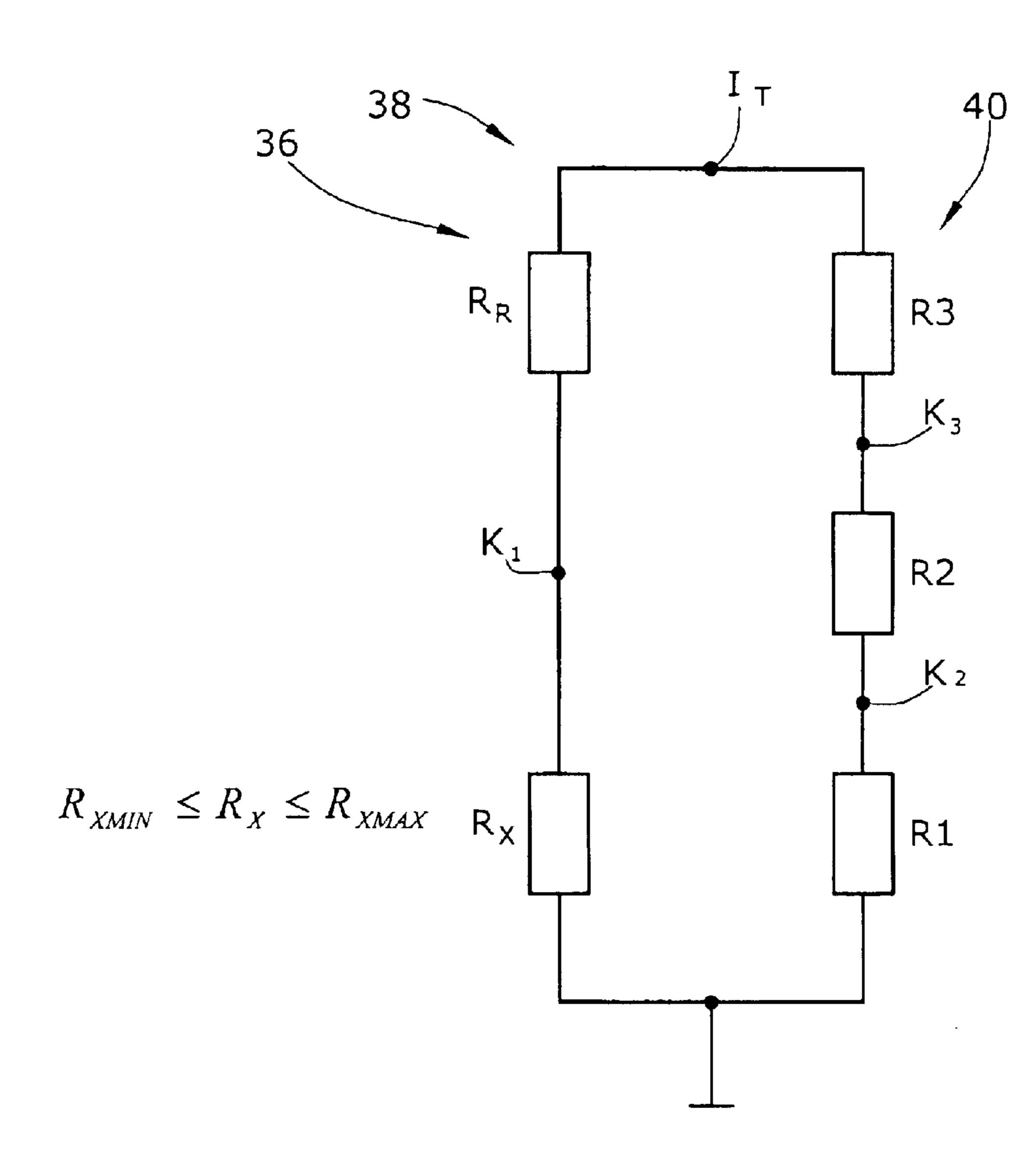
$$\frac{R_{XMAX}}{R_R + R_{XMAX}} = \frac{R_1 + R_2}{R_1 + R_2 + R_3}$$
