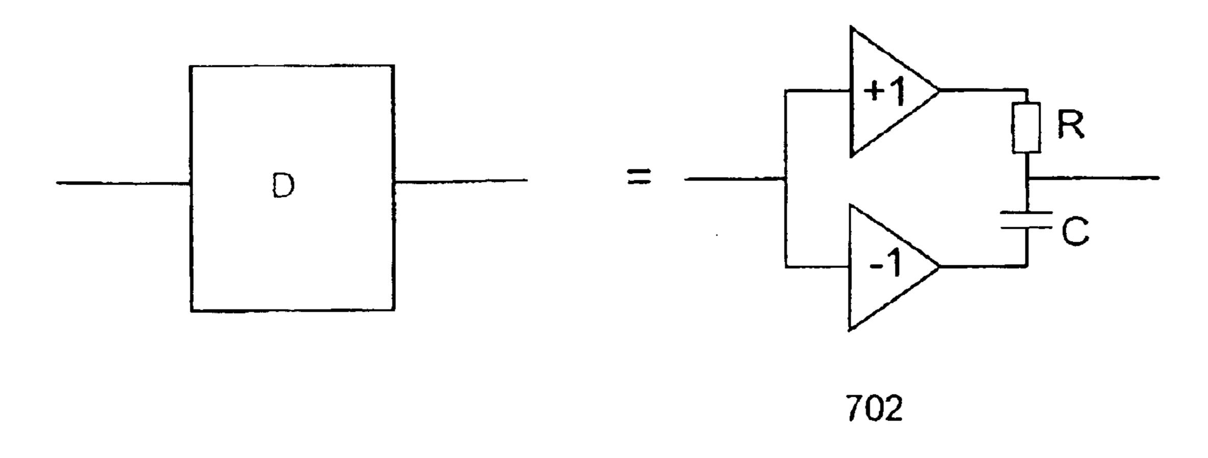
$$H(\omega) = \frac{1 - i\omega RC}{1 + i\omega RC} \approx e^{-i\omega 2RC}$$
