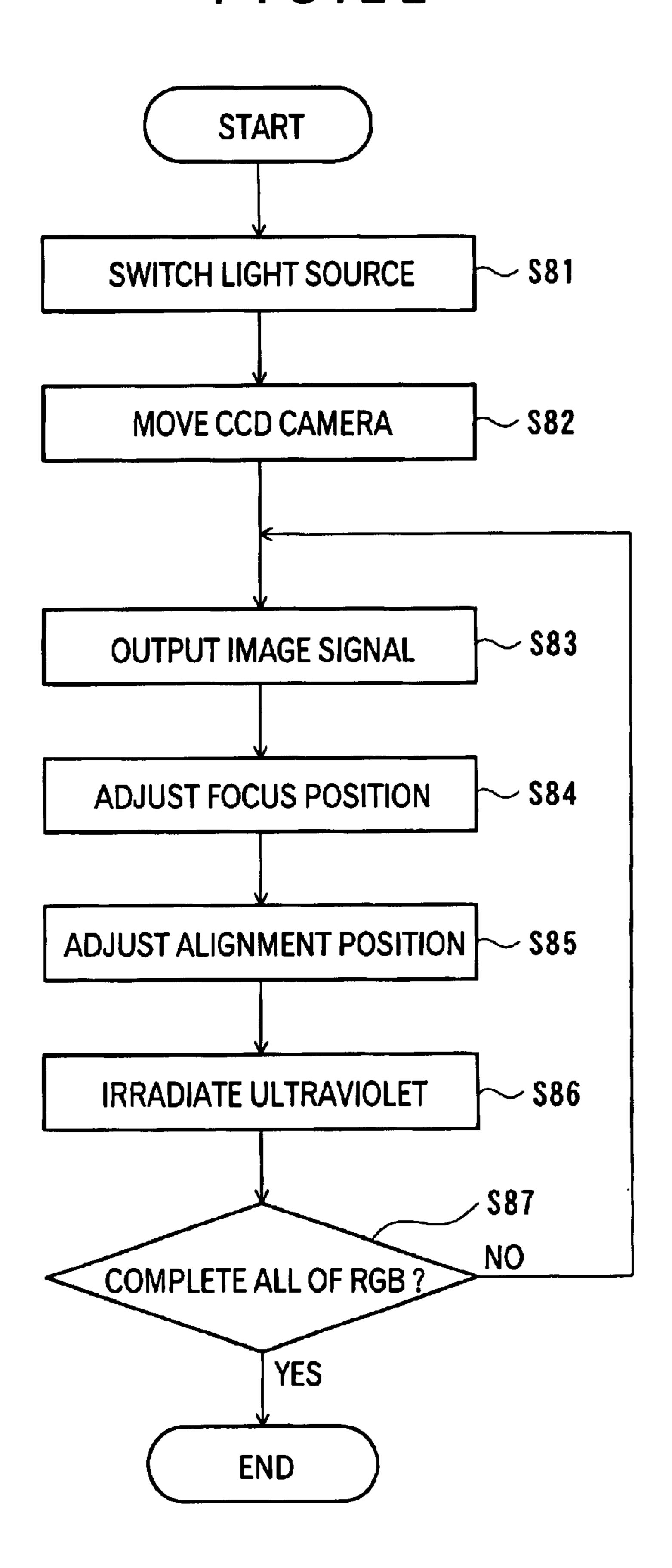
POSITION ADJUSTING METHOD AND POSITION ADJUSTING SYSTEM OF COLOR COMBINING OPTICAL SYSTEM, POSITION ADJUSTING METHOD AND POSITION ADJUSTING SYSTEM OF OPTICAL MODULATOR, COLOR COMBINING OPTICAL SYSTEM AND PROJECTOR
