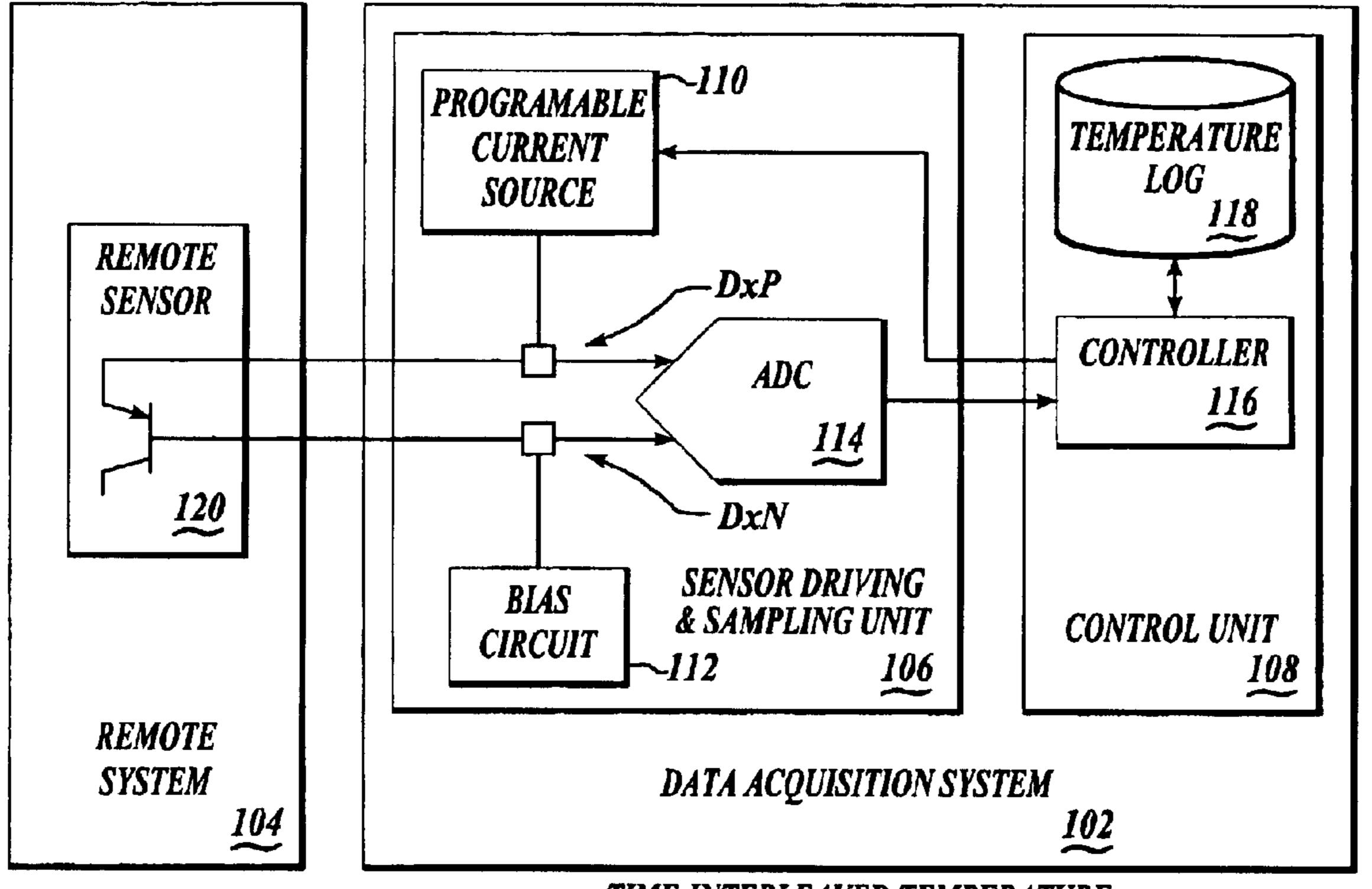
TIME-INTERLEAVED TEMPERATURE MEASUREMENT SAMPLING SYSTEM
