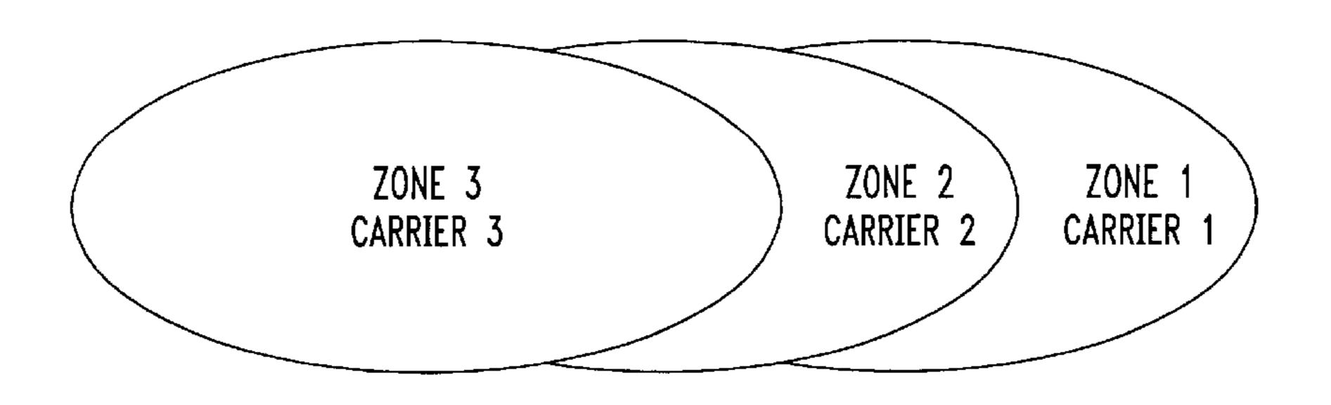
330 CELL 30  $\times$ 300 9 •15% OVERLAPPING TO ALLOW CELL BREATHING IN ZONE POWER IS REDUCED FOR ZONES 2 AND 3 RESPECTIVELY 0.75 >-90 120 240 150 300 9 0.75 270  $\times$ CELL 1 120 240 7 150 180 ZONE 2 2 CARRIER **20NING** ZONE 1 CARRIER ZONE 3 CARRIER
