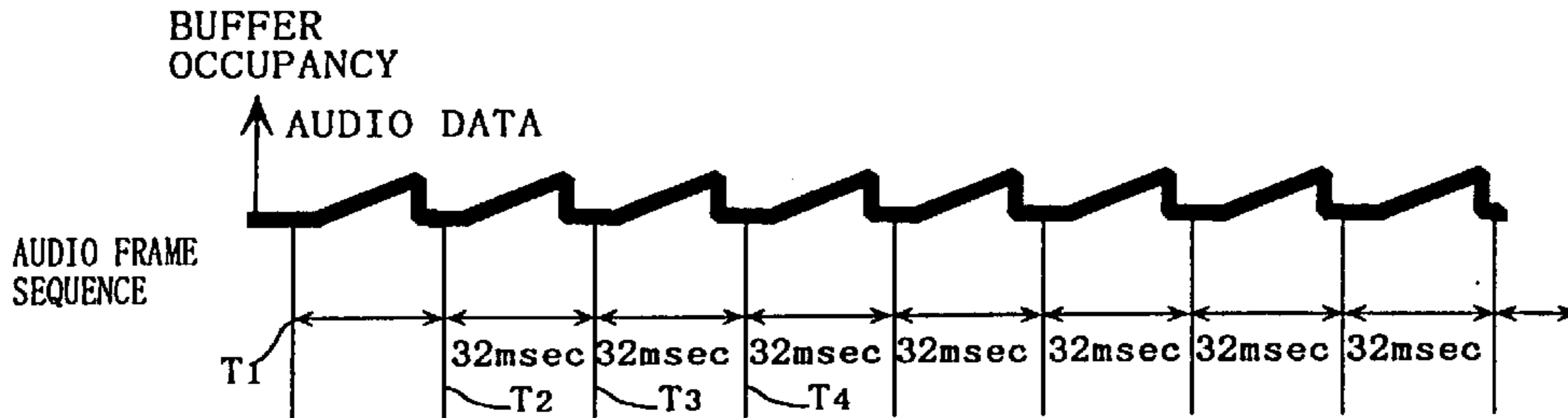
FIG. 7B ACTUAL BUFFER STATE
